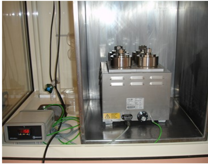
Şekil 5.14 Nano-Titanyumdioksit sentezinde kullanılan hidrotermal reaktör
