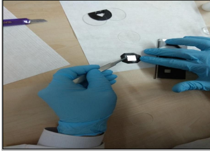
Şekil 7.66 Radyoaktif ince film kaplama – maskeleme
