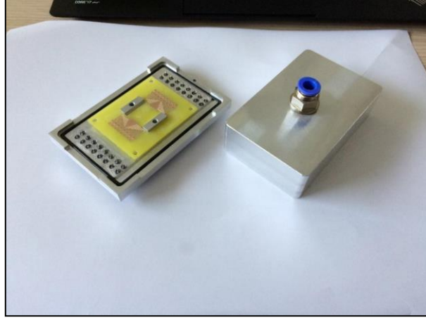
Şekil 7.55 Vakum hücresi ve PCB'nin yerleşimi
