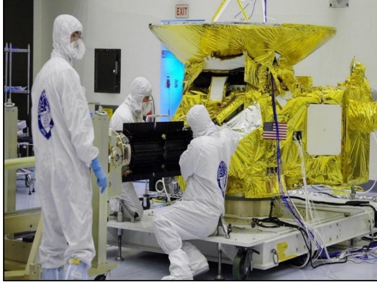
Şekil 4.4 Radyoizotop termoelektrik üreticinin NASA uzay aracı New Horizons'a yüklenmesi
