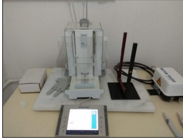
Şekil 7.72 Ayrılan Ni-63 radyoaktif sıvının tartıldığı hassas elektronik tartı sistemi
