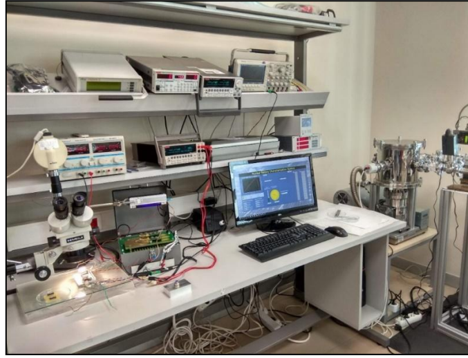
Şekil 7.76 Betavoltaik nükleer pil karakterizasyon sistemi
