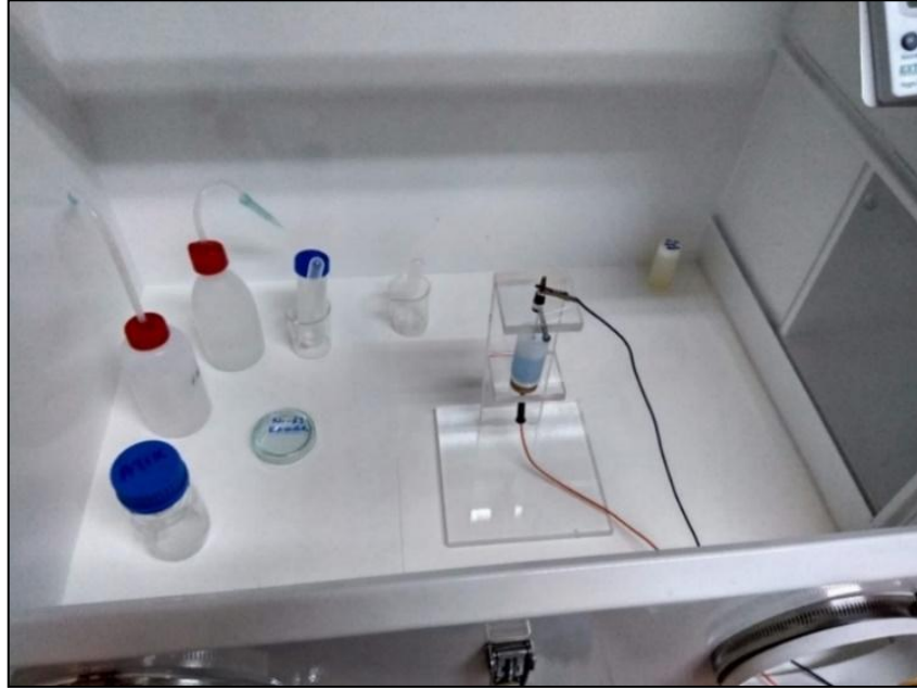
Şekil 7.74 Ni-63 Radyoaktif ince film elektroliz kaplama çalışmaları
