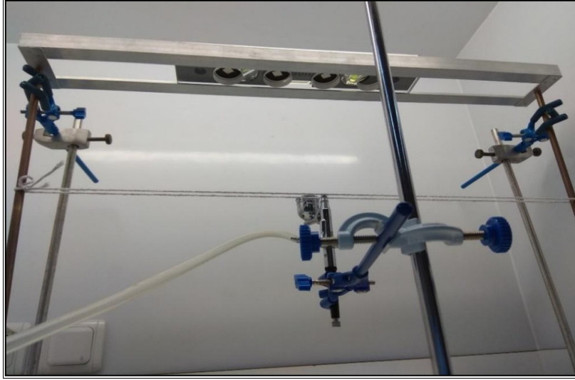
Şekil 7.68 Mikro küreciklerin metal yüzeye homojen olarak dağıtılması
