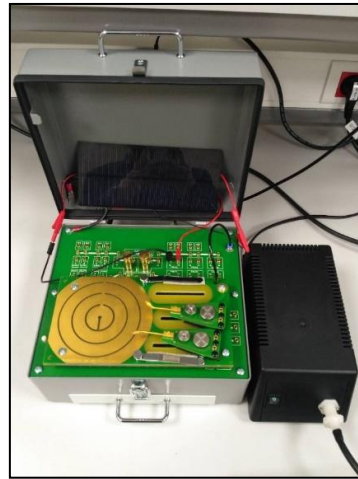
Şekil 7.77 Betavoltaik nükleer pil karakterizasyon sistemi
