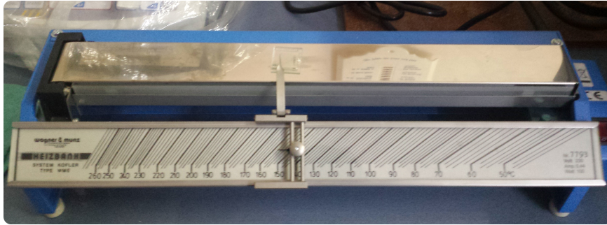
Şekil 4.12 Hücrelere sıvı kristal örneklerin konulması sırasında kullanılan, sıcaklık gradyenine sahip Kohler bankası.
