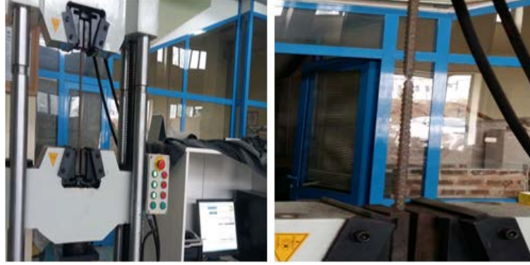
Şekil 4. 6 Çelik çekme deney düzeneği
