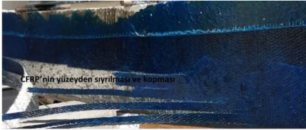
Şekil 4. 37 K40KGU deney kirişinin göçme mekanizması
