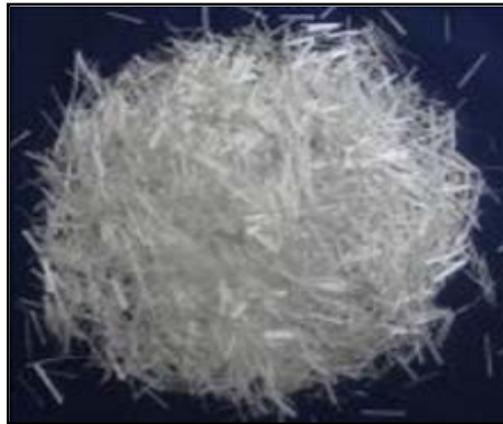
Şekil 2. 2 Kırpılmış cam lif [56]
