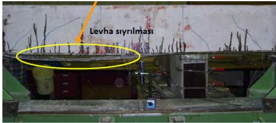
Şekil 6. 2 BFS-1 kirişinin göçme mekanizması [4]
