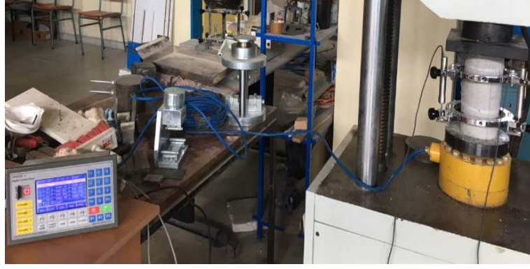
Şekil 4. 3 Silindir beton numune deneyi
