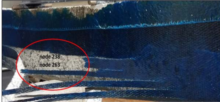
Şekil 6. 61 K40KGU deney kirişinde CFRP kumaşın sıyrıldığı noktalar
