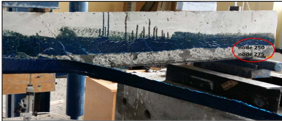
Şekil 6. 30 K20KG50 deney kirişinin ön yüzünde CFRP kumaşın sıyrıldığı noktalar
