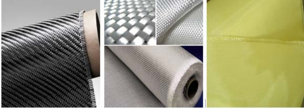
Şekil 2. 6 CFRP, GFRP ve AFRP kumaş [78]
