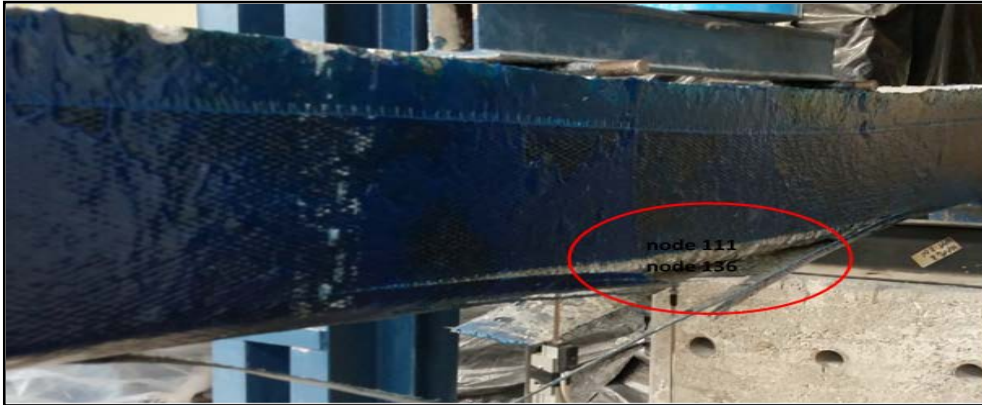
Şekil 6. 38 K20KGU deney kirişinin arka yüzünde CFRP kumaşın sıyrıldığı noktalar
