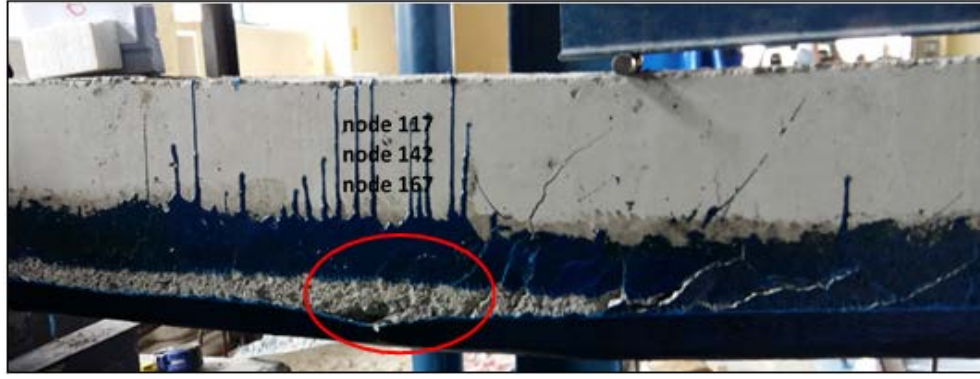
Şekil 6. 31 K20KG50 deney kirişinin arka yüzünde CFRP kumaşın sıyrıldığı noktalar
