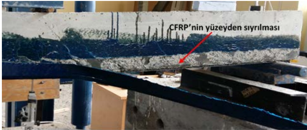
Şekil 4. 27 K20KG50 deney kirişinin göçme mekanizması
