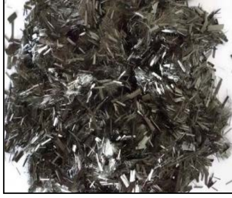
Şekil 2. 1 Kırpılmış karbon lif [53]
