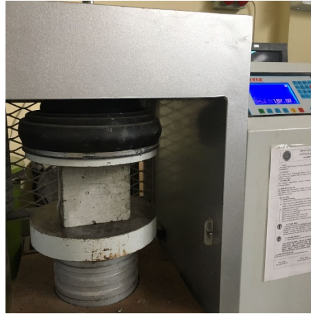
Şekil 4. 2 Beton basınç dayanım deneyi
