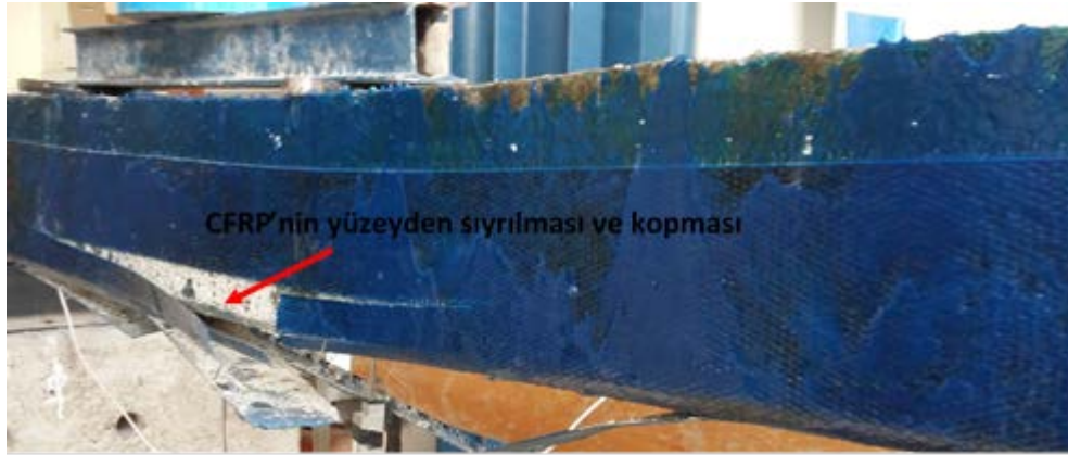
Şekil 4. 29 K20KGU deney kirişinin göçme mekanizması
