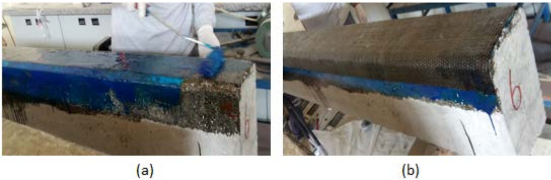
Şekil 4. 15 Deney kirişlerine CFRP uygulaması a) kiriş yüzeyine epoksi uygulaması b) CFRP malzemenin yapıştırılması
