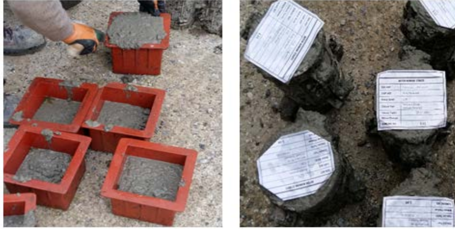
Şekil 4. 1 Hazırlanan küp ve silindir beton numuneleri
