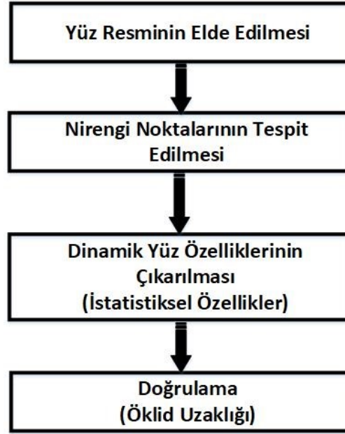
Şekil 2.1 Yüz dinamiklerine dayalı yüz tanıma yönteminin adımları.
