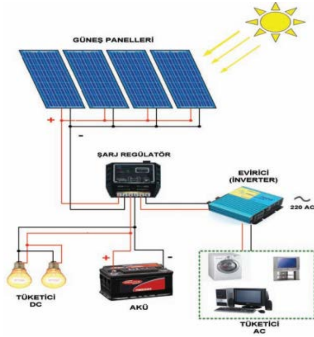
Şekil 2.8 PV sistemlere ait şema [64]
