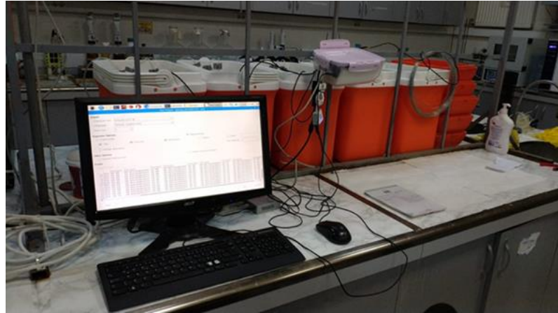
Şekil 3.8 Kompost reaktörlerinin sıcaklık ölçümlerinin takibi için geliştirilen yazılımın reaktörlerle görünümü
