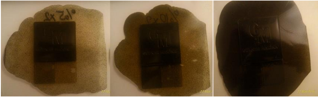
Şekil 4.24 Farklı oranlarda deniz yosunu ve PLA karıştırılarak elde edilmiş biyoplastikler
