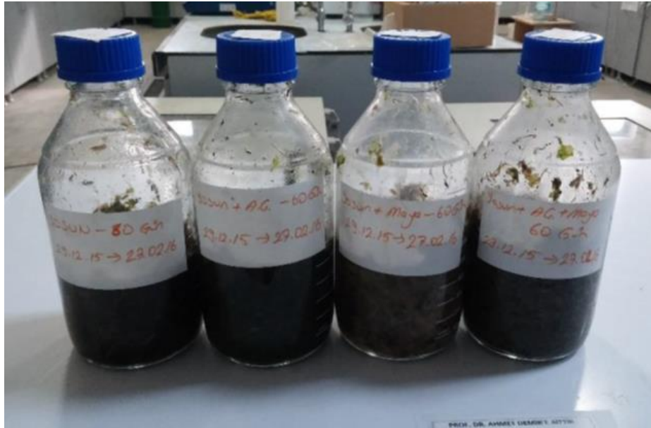
Şekil 3.2 Yosunun biyolojik yolla ekstrakte edilmesinde kullanılan reaktörler
