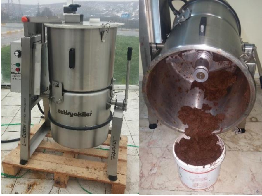
Şekil 3.5 Makroalglerin öğütülmesi işleminde kullanılan sebze doğrama makinesi
