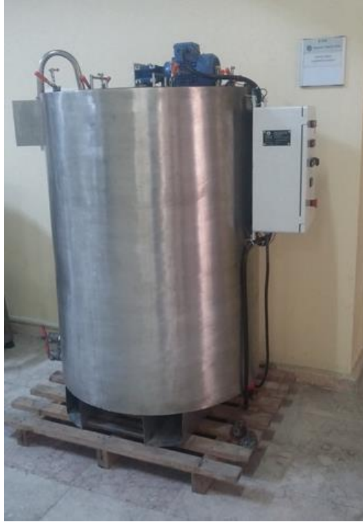
Şekil 3.6 Sıvı gübre üretiminde kullanılan pilot ölçekli anaerobik reaktör
