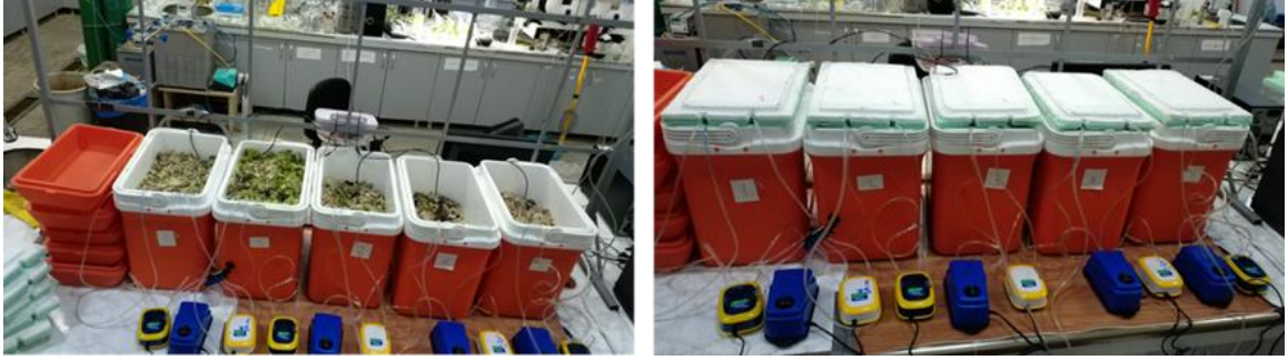
Şekil 3.9 Atık karışımı ile beslenmiş ve strafor kapaklar ile yalıtılmış biyoreaktörler
