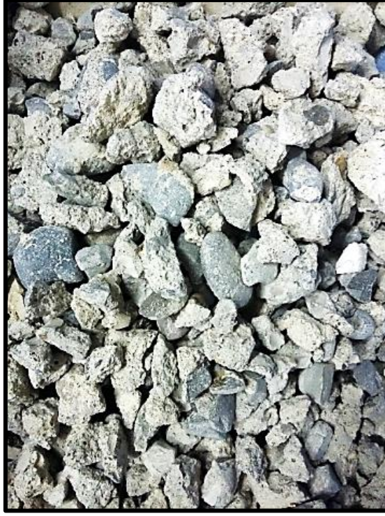
Şekil 4.2 Geri kazanılmış agrega genel görünüşü
