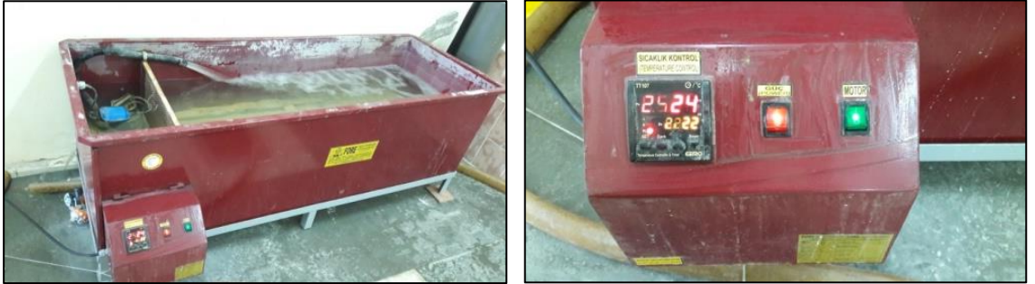
Şekil 3.2 Numunelerin kirece doymun suda kürü
