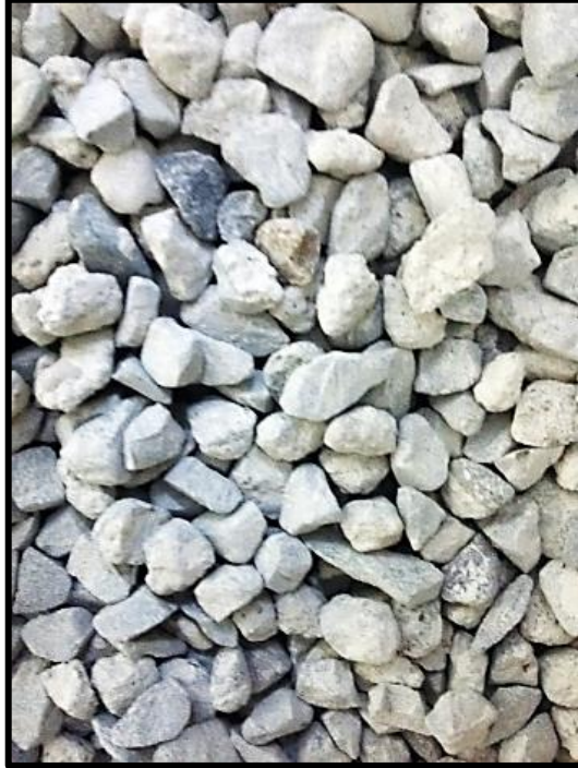
Şekil 4.3 İyileştirilmiş geri kazanılmış agrega genel görünüşü
