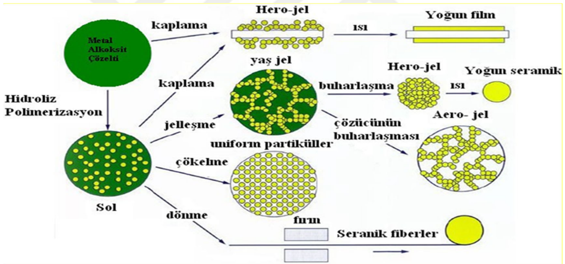
Şekil 3.4 Sol-Jel Prosesinin Basamakları Şeması (Chen and Soutar, 2009: 79-95)
