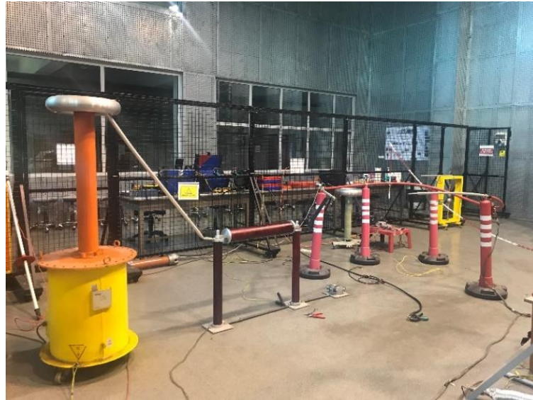
Şekil 5.5 Alternatif yüksek gerilim ile yaşlandırma düzeneđi
