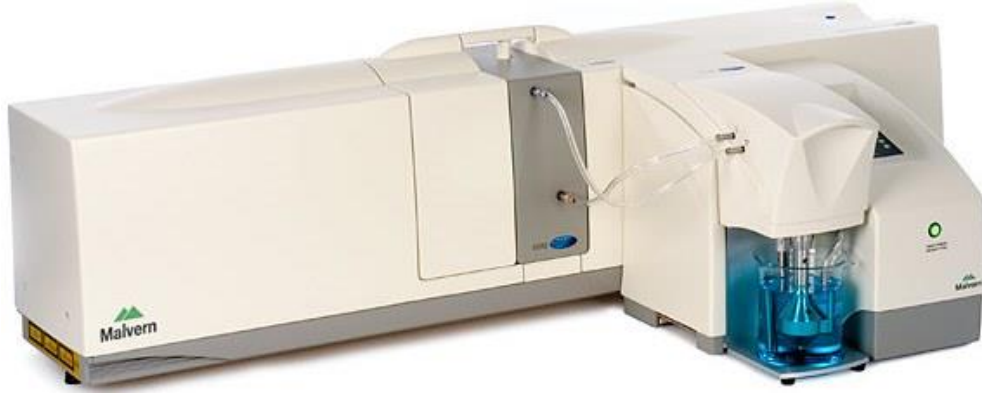
Şekil 2.10 Partikül boyut dağılımının belirlenmesinde kullanılan cihaz
