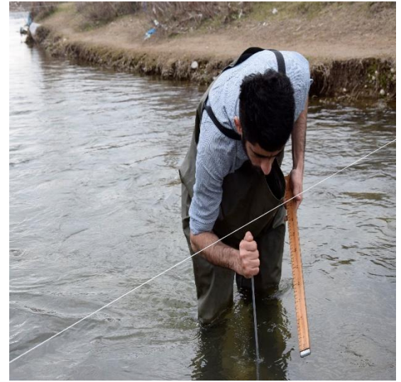
Şekil 6.6 Pitot Tüpü ölçümü, su seviyesi belirleme ve enkesit belirleme çalışmaları
