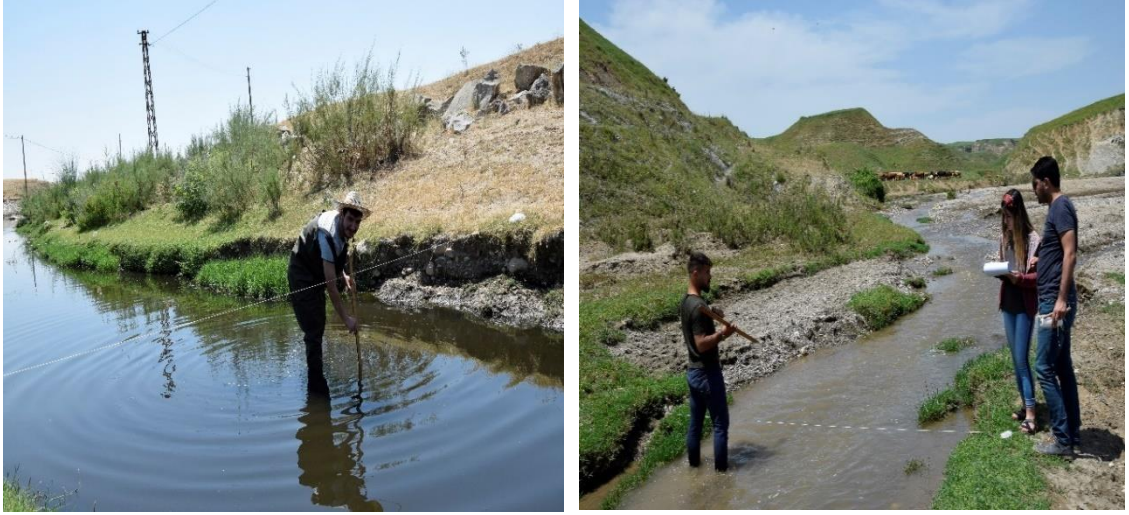
Şekil 6.4 Yüzgeçler Yöntemi ile yüzey hızı ve enkesit belirleme çalışmaları
