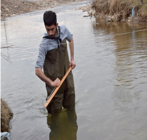
Şekil 6.6 Pitot Tüpü ölçümü, su seviyesi belirleme ve enkesit belirleme çalışmaları
