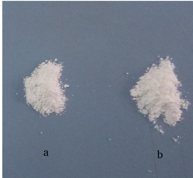
Şekil 3. 1 Deneylerde kullanılan ticari TiO 2 ’ler a) Sigma Anatase, b) Degussa P25
