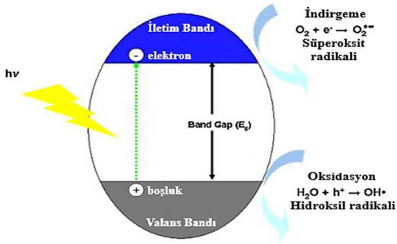
Şekil 2. 4 Fotokatalitik reaksiyon sırasında elektron-boşluk çifti oluşumu [77]
