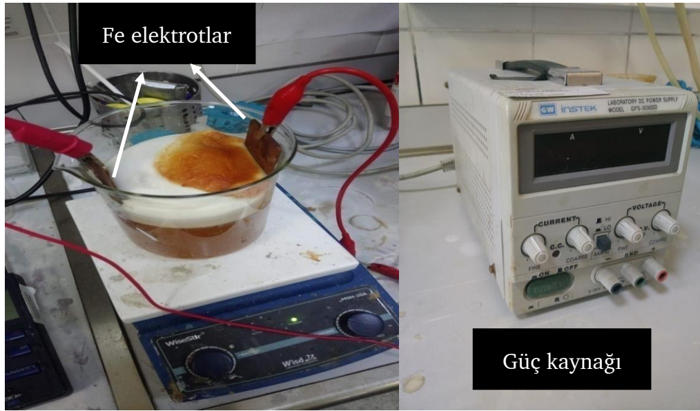
Şekil 3. 2 Elektro-Fenton deney düzeneği
