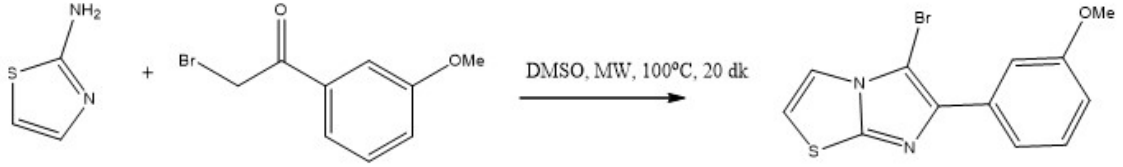
Şekil 4.9 Çözücü olarak DMSO kullanımı imidazotiyazol sentezi
