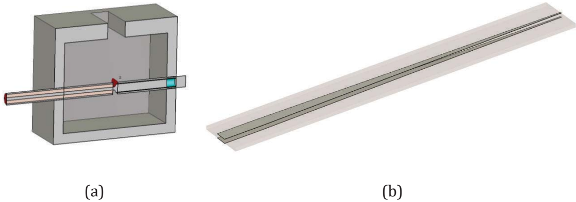
Şekil 3.41 (a) Marchand balun topolojisi genel görünümü, (b) konik geçişli paralel mikroşerit hatlı empedans dönüştürücü genel görünümü
