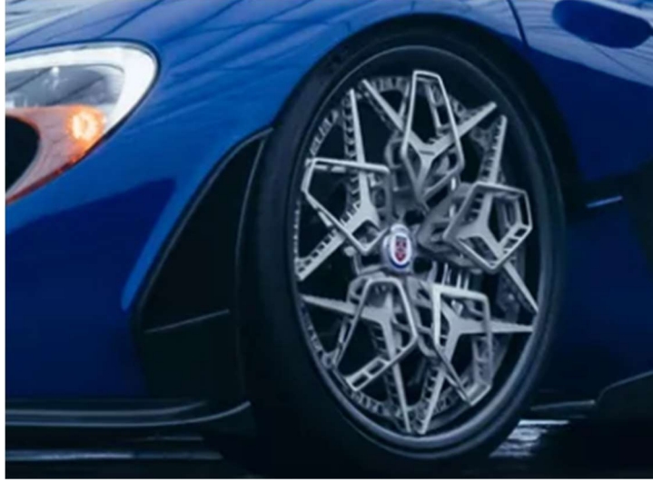
Şekil 2.12 EBM teknolojisiyle üretilmiş titanyum jant [18]
