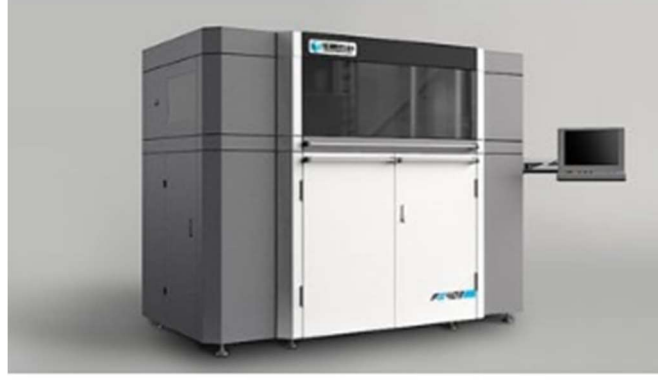
Şekil 2.9 SLS üretim tezgâhı örneği [15]
