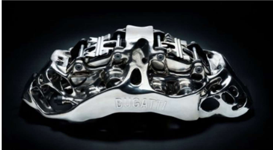
Şekil 2.13 SLM teknolojisiyle üretilmiş fren kaliperi [20]
