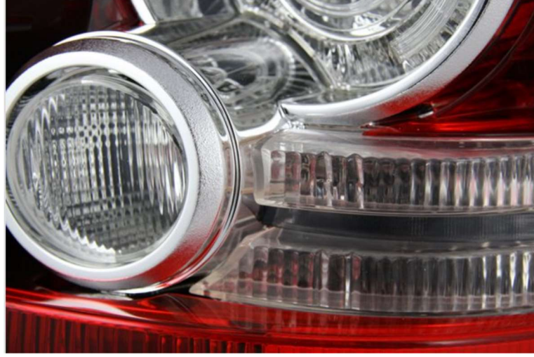
Şekil 2.8 SLA tekniğiyle üretilmiş arka aydınlatma sistemi [14]
