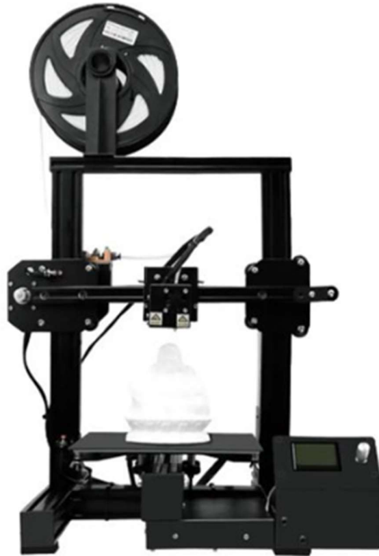
Şekil 2.5 FDM üretim tezgahı örneği [12]
