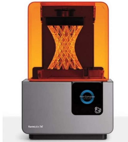
Şekil 2.7 SLA üretim tezgâhı örneği [13]
