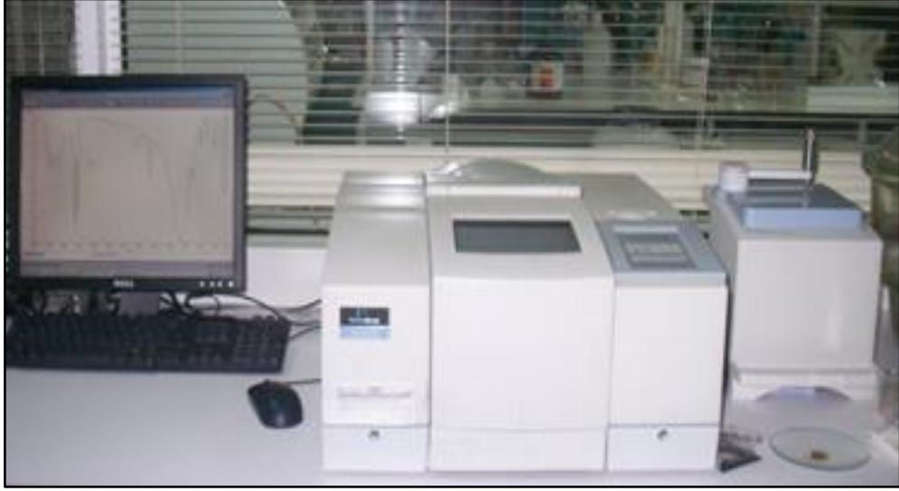
Şekil 4.8 Perkin Elmer Spectrum One marka FTIR cihazı
