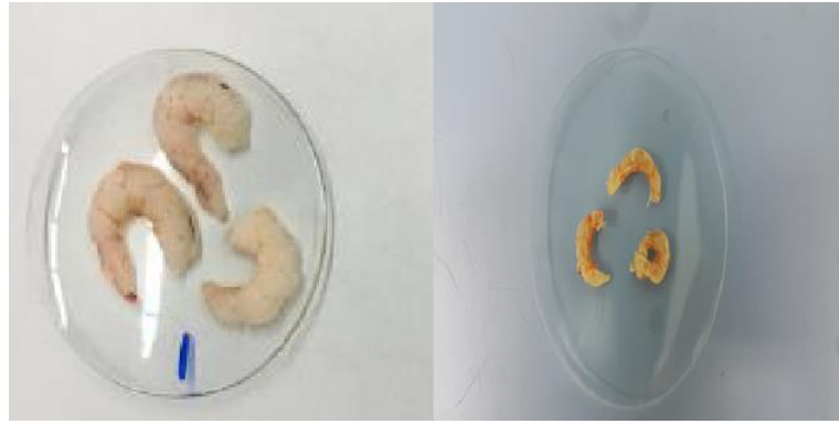
Şekil 4.22 Infrared cihazında 80°C’de kurutma işlemi uygulanmasından önceki ve sonraki durum
