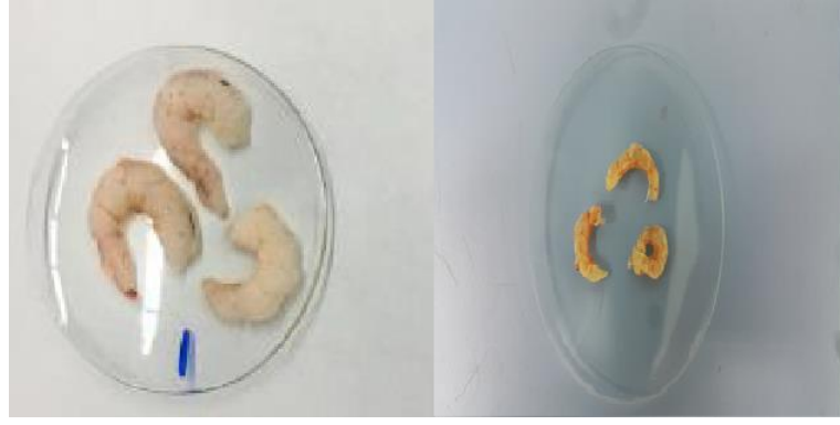
Şekil 4.21 Infrared cihazında 70°C’de kurutma işlemi uygulanmasından önceki ve sonraki durum
