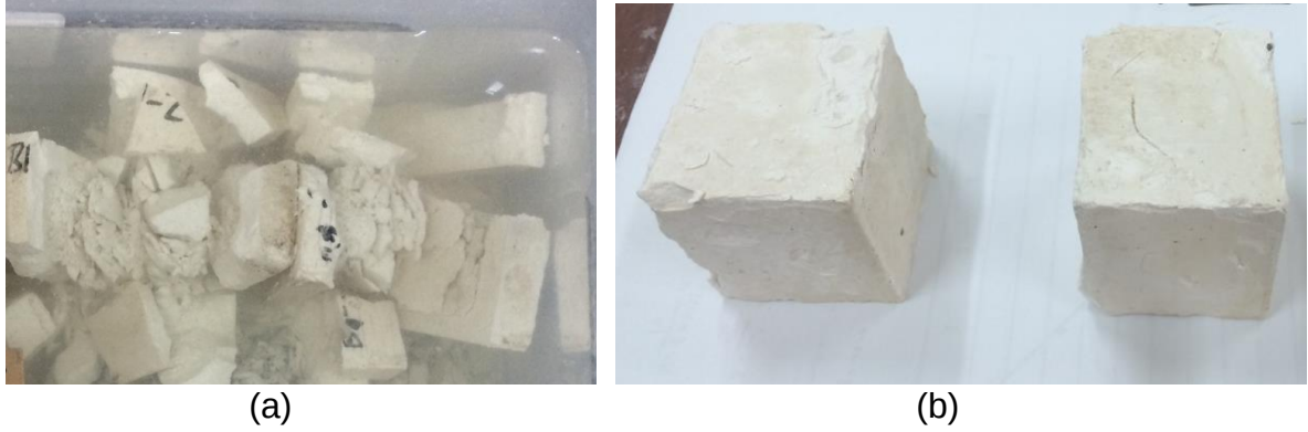
Şekil 4.8 (a) 4. Çevrimde tamamen dağılan hava kireci içeren enjeksiyon malzemesi (b) 11. Çevrimde çatlak oluşan hidrolik kireç içeren enjeksiyon malzemesi (Oktay, 2017)
