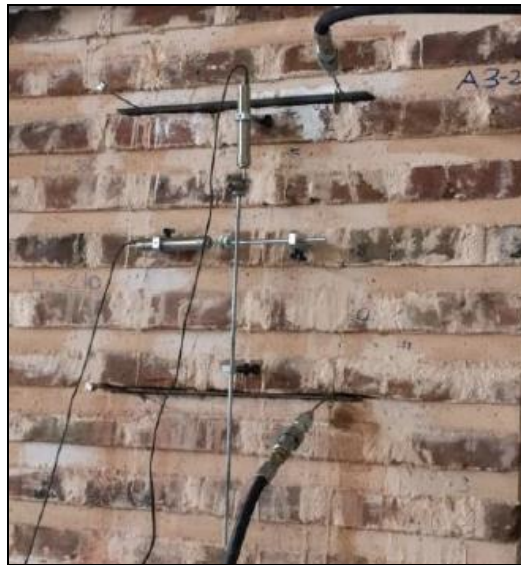
Şekil 5.6 Çift plaka ile ölçüm (Oktay, 2017)
