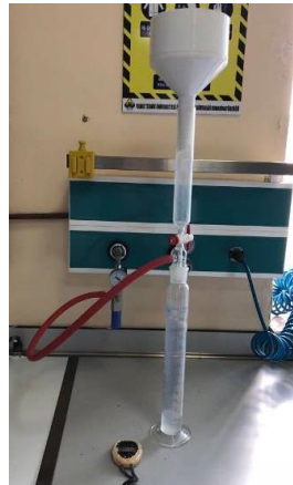
Şekil 3.5 Su tutma kapasitesinin belirlenmesi
