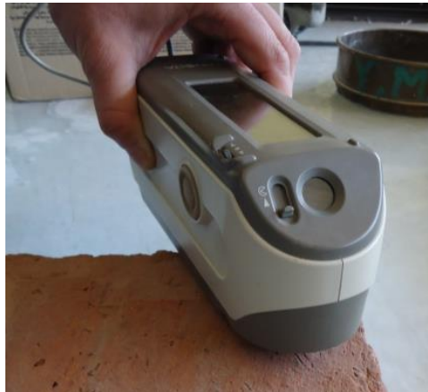
Şekil 4.4 Görsel analiz için spektrofotometre ile renk ölçümü (Ulukaya, 2016)
