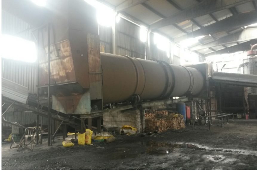
Şekil 4. 4 Milten Müteahhitlik kurutma tesisi döner fırını
