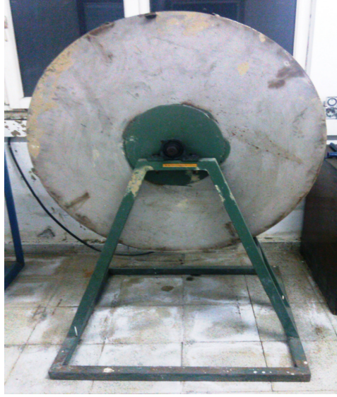
Şekil 4. 16 Aşınma sağlamlığı testinde kullanılan tambur
