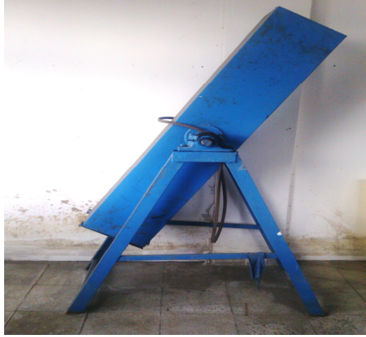
Şekil 4. 18 Düşme sağlamlığı testinde kullanılan cihaz
