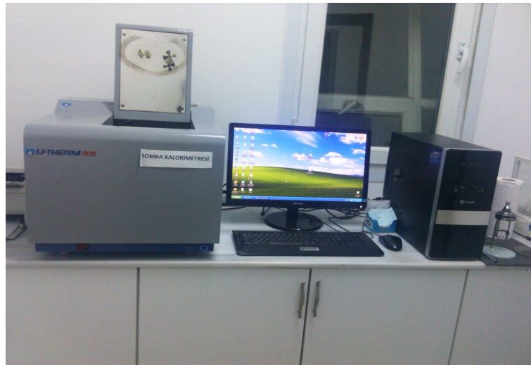
řekil 4. 7 Deneylerde kullanılan kalorimetre cihazı
