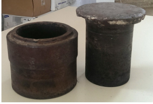
Şekil 4. 11 Briketlemede kullanılan silindirik kalıp
