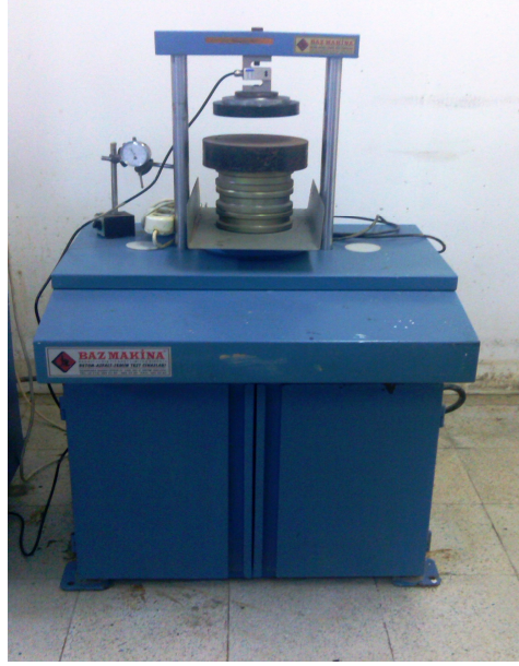
Şekil 4. 17 Kırılma sağlamlığı testinde kullanılan paralel levhalı pres
