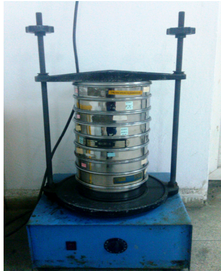
Şekil 4. 5 Elek analizinde kullanılan elek sarsma cihazı
