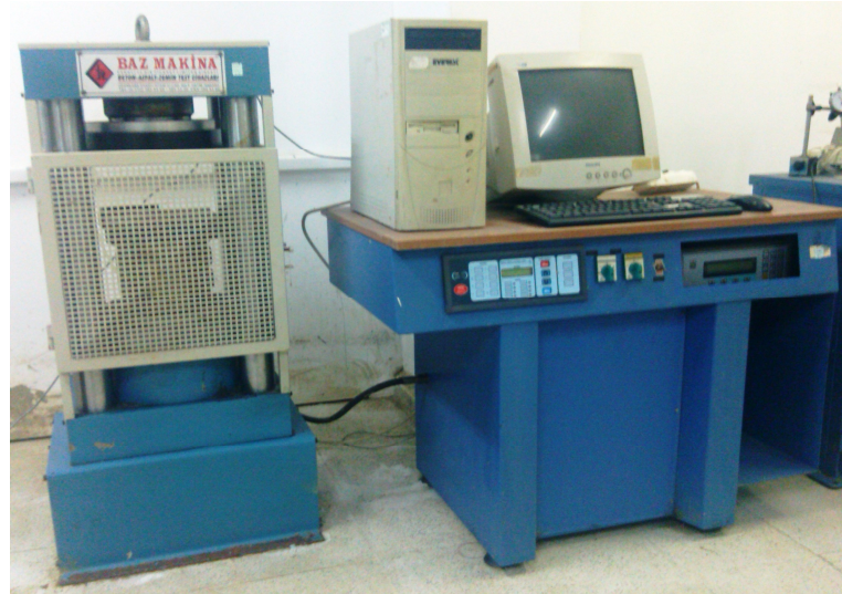
Şekil 4. 10 Deneylerde kullanılan hidrolik pres
