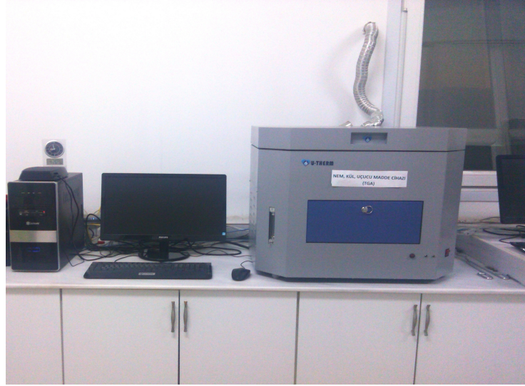
Şekil 4. 9 Deneylerde kullanılan nem-kül-uçucu madde tayin cihazı (TGA)
