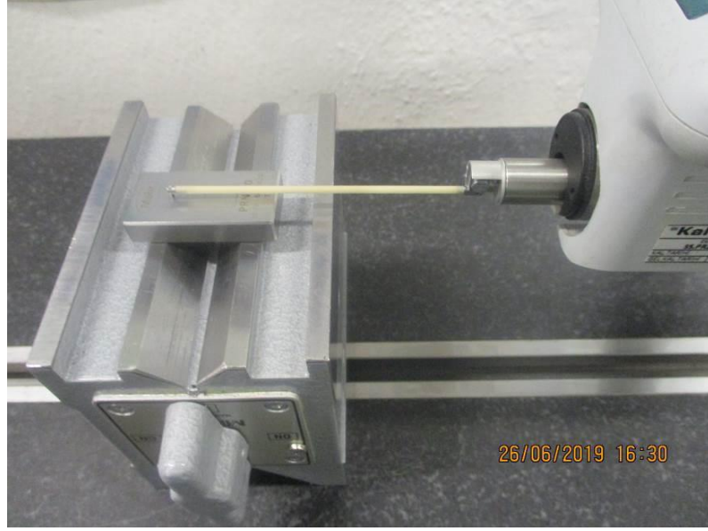
Şekil 3.4 Yüzey pürüzlülük ölçüm cihazı
