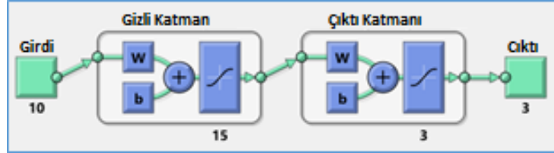
Şekil 5.1 İleri Beslemeli Geri Destekli Model’in Şematik Gösterimi
