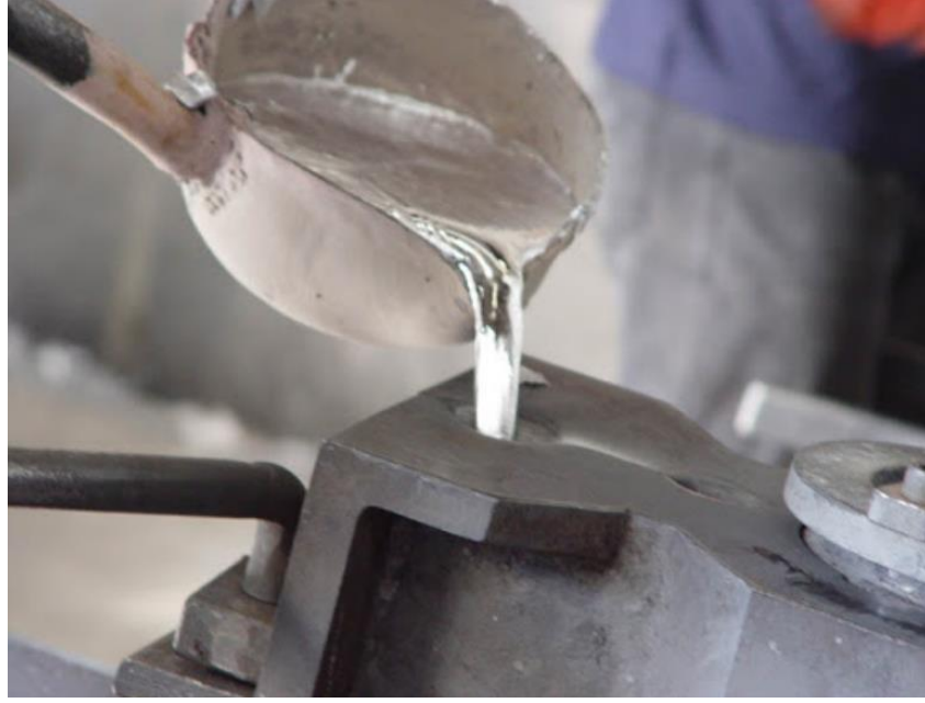
Şekil 2.1 Alüminyum döküm prosesi [19]
