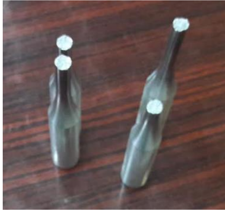
Şekil 2.16 Yorulma Testi Sonucu Kırılan Numuneler
