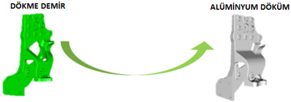
Şekil 3.7 Dökme Demir Tasarımdan Alüminyum Tasarıma Geçiş
