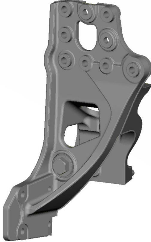
Şekil A.3 Süspansiyon Braketi Sonlu Elemanlar Modeli Soldan Görünüm
