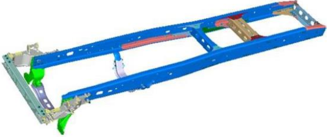
Şekil 3.15 Modal ve Rijitlik Analizlerinde Kullanılan Geometri
