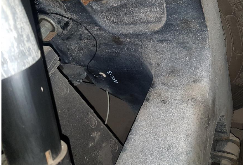
Şekil 3.10 Orta Süspansiyon Sol Teker İvme Ölçer Konumu
