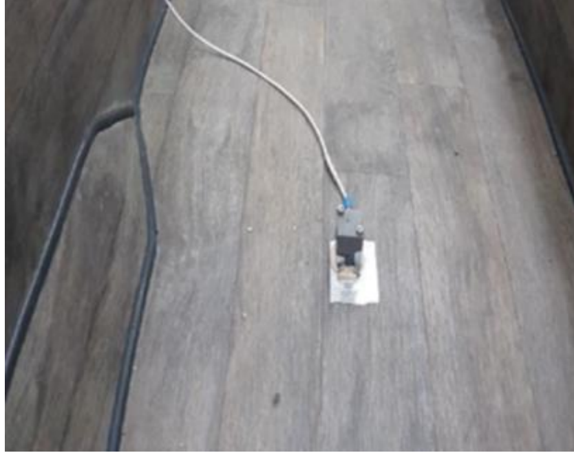
Şekil 3.15 Arka Gövdenin Ağırlık Merkezine Yerleştirilen İvmeölçer Konumu
