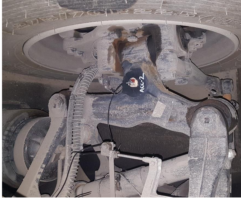
Şekil 3.9 Ön Süspansiyon Sağ Teker İvme Ölçer Konumu
