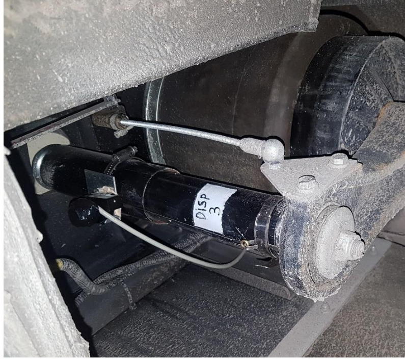
Şekil 3.4 Orta Sol Amortisör Deplasman Ölçer Konumu
