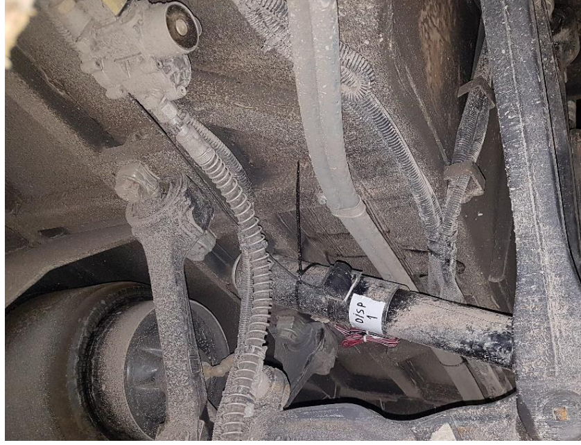
Şekil 3.2 Ön Sol Amortisör Deplasman Ölçer Konumu
