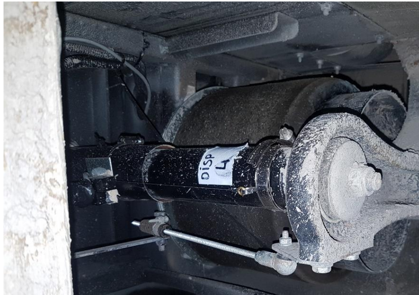
Şekil 3.5 Orta Sağ Amortisör Deplasman Ölçer Konumu
