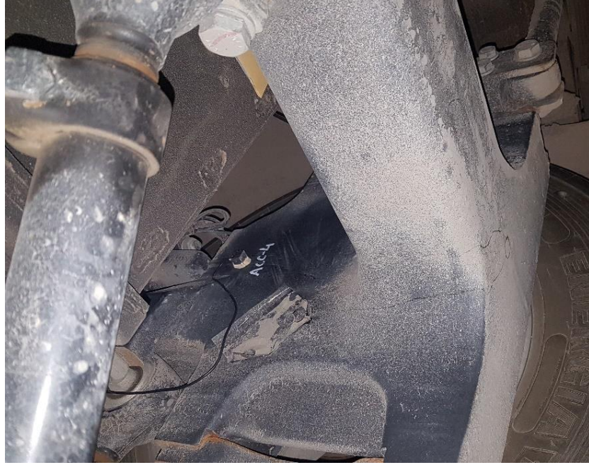
Şekil 3.11 Orta Süspansiyon Sağ Teker İvme Ölçer Konumu
