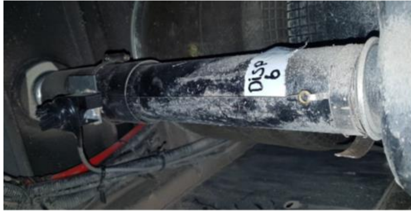
Şekil 3.7 Arka Sağ Amortisör Deplasman Ölçer Konumu
