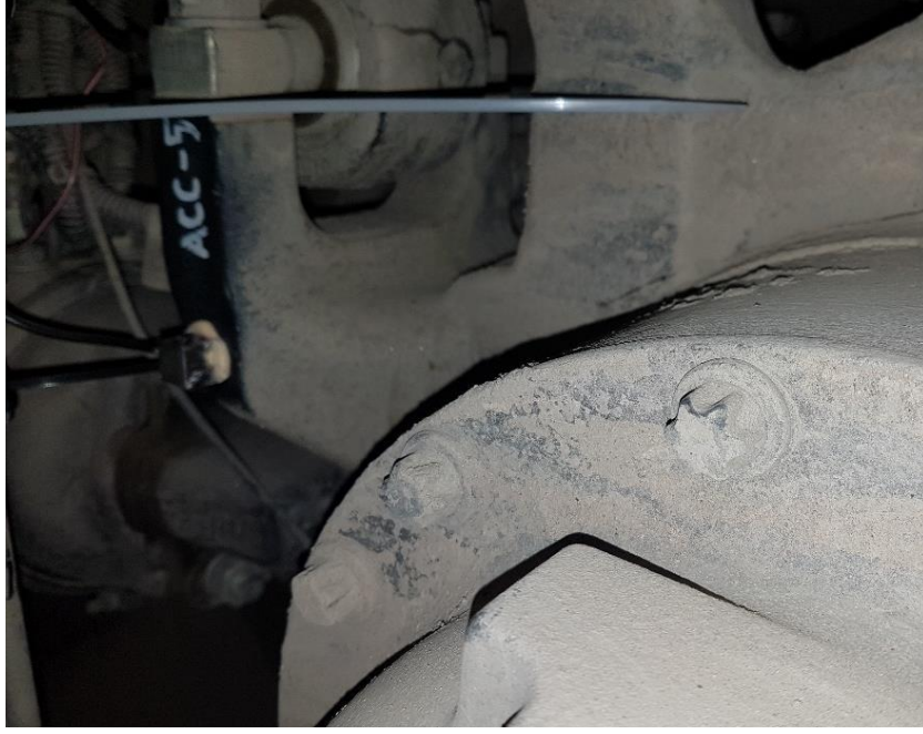
Şekil 3.12 Arka Süspansiyon Sol Teker İvme Ölçer Konumu
