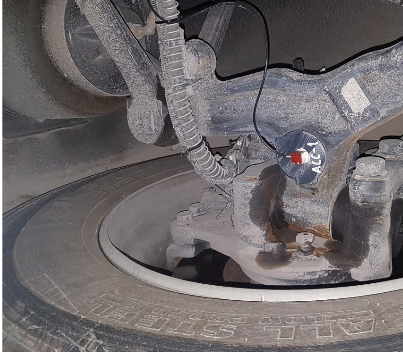
Şekil 3.8 Ön Süspansiyon Sol Teker İvme Ölçer Konumu
