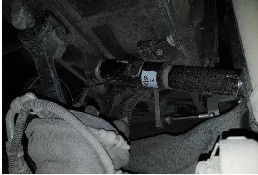
Şekil 3.3 Ön Sağ Amortisör Deplasman Ölçer Konumu
