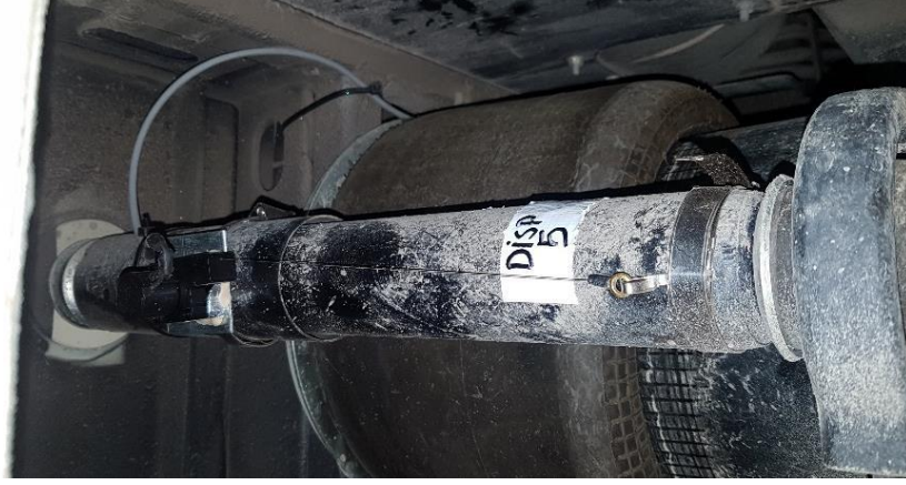
Şekil 3.6 Arka Sol Amortisör Deplasman Ölçer Konumu
