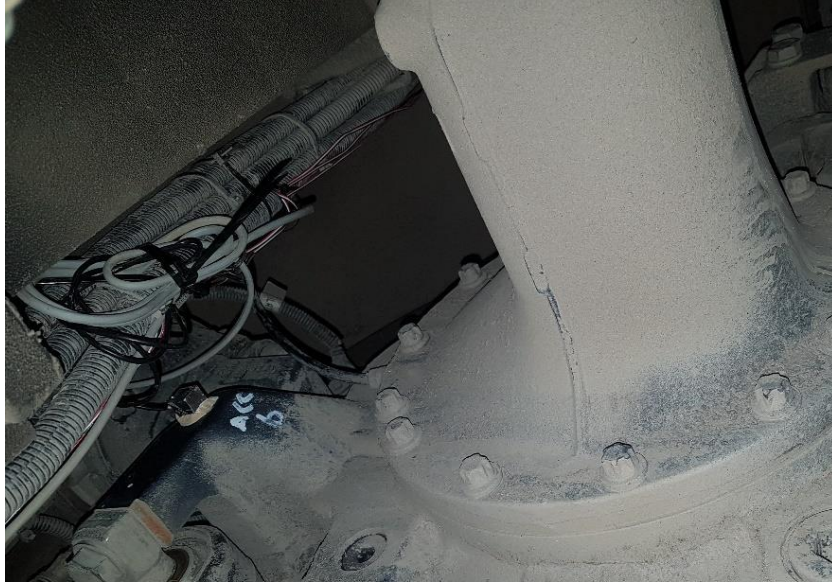
Şekil 3.13 Arka Süspansiyon Sağ Teker İvme Ölçer Konumu
