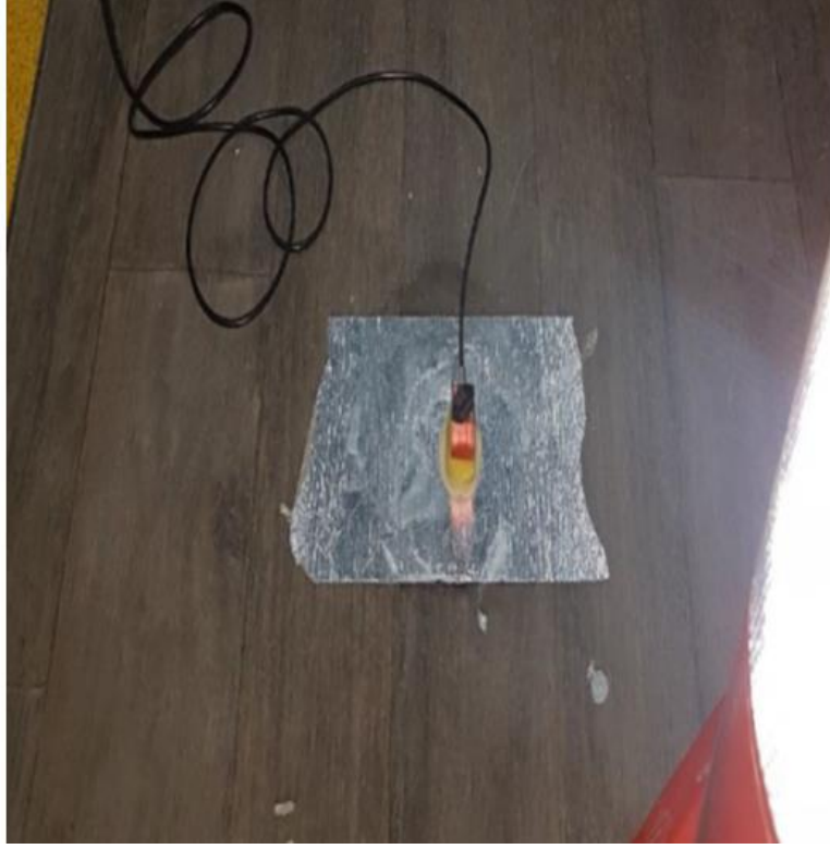
Şekil 3.14 Ön Gövdenin Ağırlık Merkezine Yerleştirilen İvmeölçer Konumu
