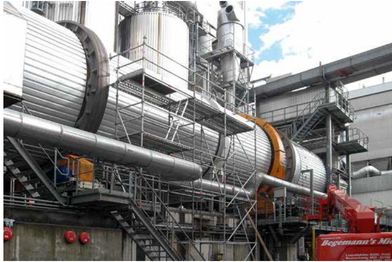
Şekil 6.5 Dolaylı ısıtmalı döner boru demetli kurutma sistemi (Büttner, 2019)
