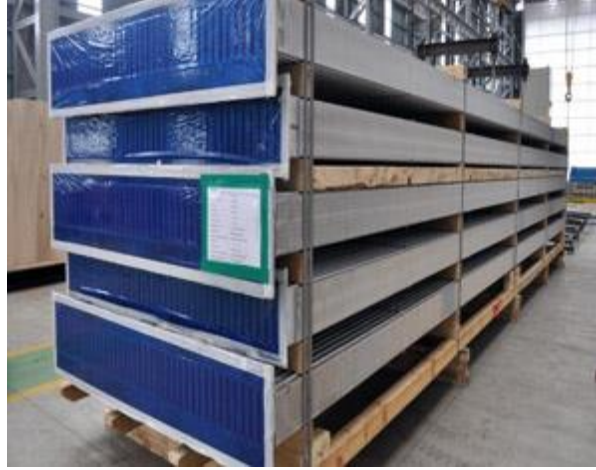
Şekil 5.5 Hava soğutmalı kondenserin tüp demeti (Energyen Corporation, 2015)
