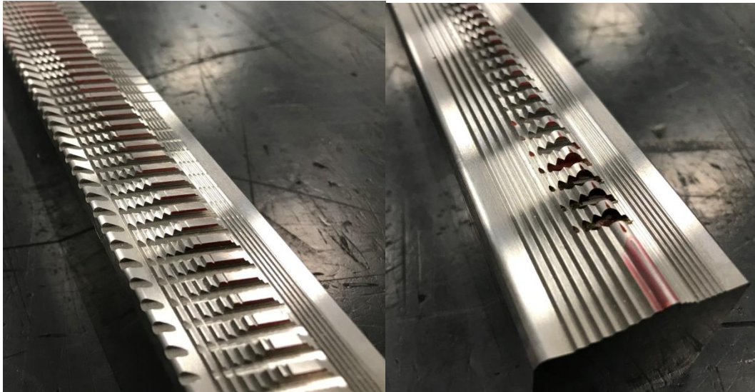
Şekil 4.15 Örnek bir yüzey profil broş takımında orta bölgedeki kesici dişler ve profil formunu tamamlayan dişlerin gösterimi
