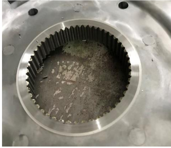
Şekil 4.7 Broşlama sonrası parça deliğinde oluşan evolvent formu
