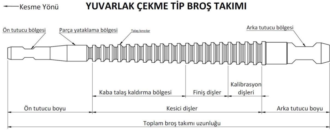
Şekil 2.2 Broş takımlarında fonksiyonel bölgeler
