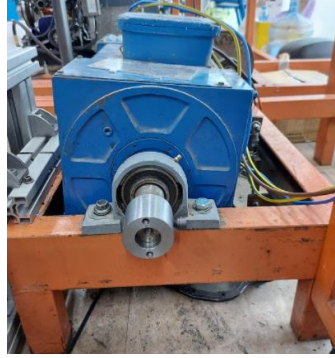
Şekil 3.6 Elektriksel güç grubu yerine kullanılan elektrik motoru
