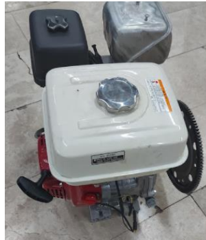
Şekil 3.5 İçten yanmalı güç grubu yerine kullanılan motor
