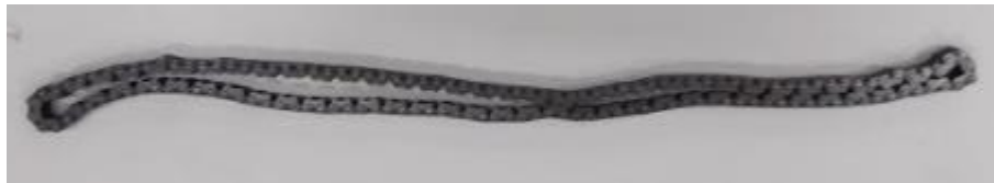
Şekil 3.2 Deney düzeneğinde kullanılan sessiz zincir
