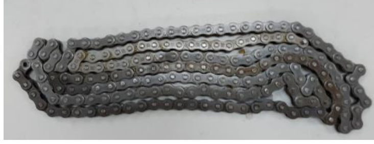
Şekil 3.8 Hibrit güç grubunda kullanılan zincir
