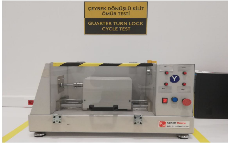
Şekil 5.47 Çeyrek dönüşlü kilit ömür testi
