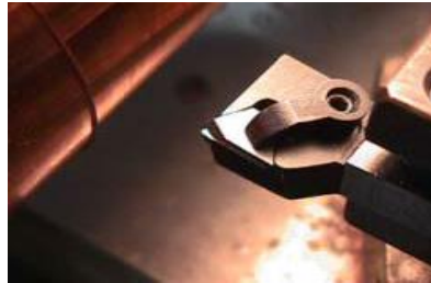
Şekil 2.7 Talaş Kırıcı Form Bulunmayan Takım
