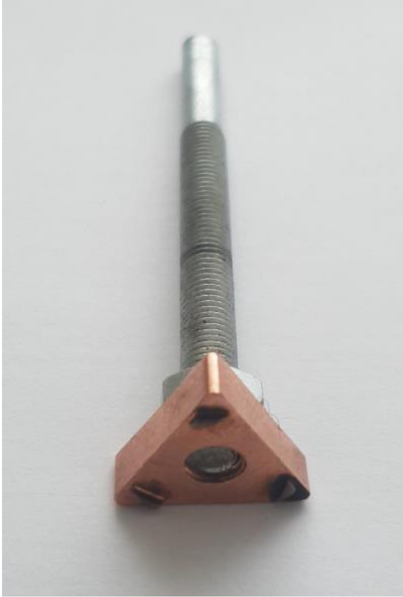
Şekil 3.13 Bakır Form Tutucu Saplama
