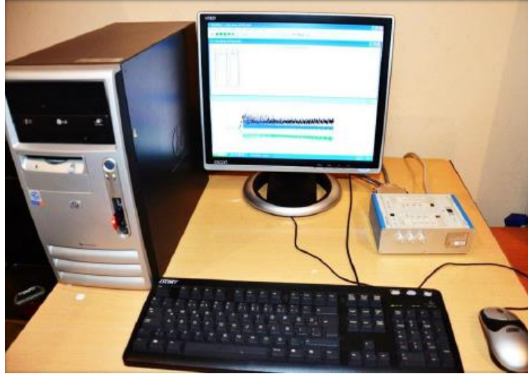
Şekil 5.8 Kesme Kuvvetleri İçin Kullanılan Kontrol Ünitesi Ve Bilgisayar
