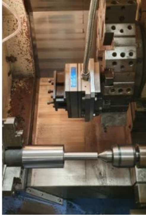
Şekil 5.9 Dinamometrenin Tezgahtaki Bağlantısı
