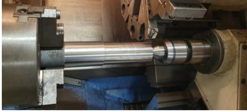
Şekil 5.5 Deneylere Hazırlanmış Parçanın Tezgaha Bağlanmış Hali
