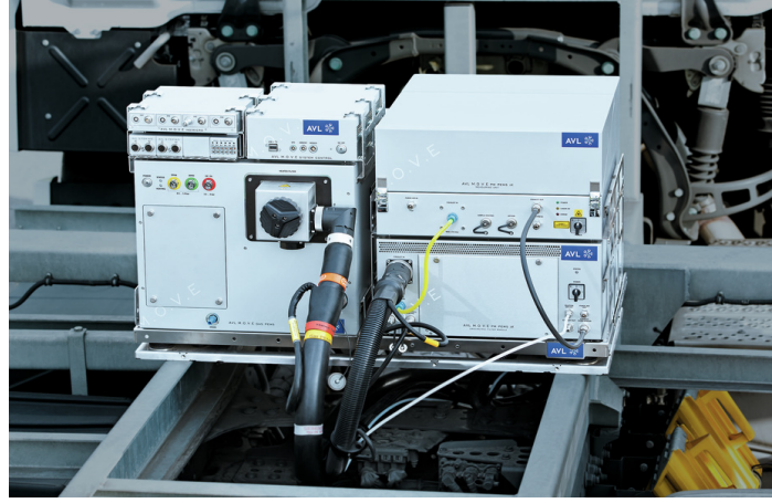
řekil 3.6 AVL Tařınabilir Emisyon  l  m Cihazı
