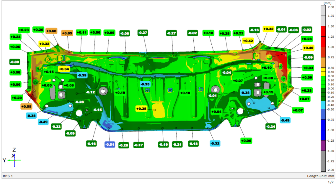
Şekil 5.19 Arka Araç Gövde Parçası_1 için Reel Ortamda Üretimi Yapılan Parçanın Cad Data ile Karşılaştırılması
