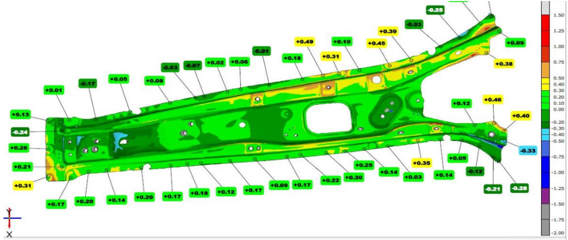
Şekil 5.86 Orta Direk Parçası için Reel Ortamda Üretimi Yapılan Parçanın Cad Data ile Karşılaştırılması
