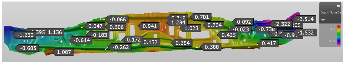
Şekil 5.55 Arka Araç Gövde Parçası_2 için Süzdürme Çubuğu Yarıçapı 7 Olacak Şekilde Yapılan Geri Yaylanma Analizi
