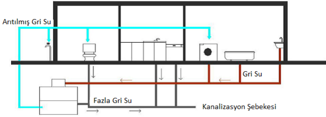
Şekil 4.6 Gri suyun konut içerisinde kullanımı [49]
