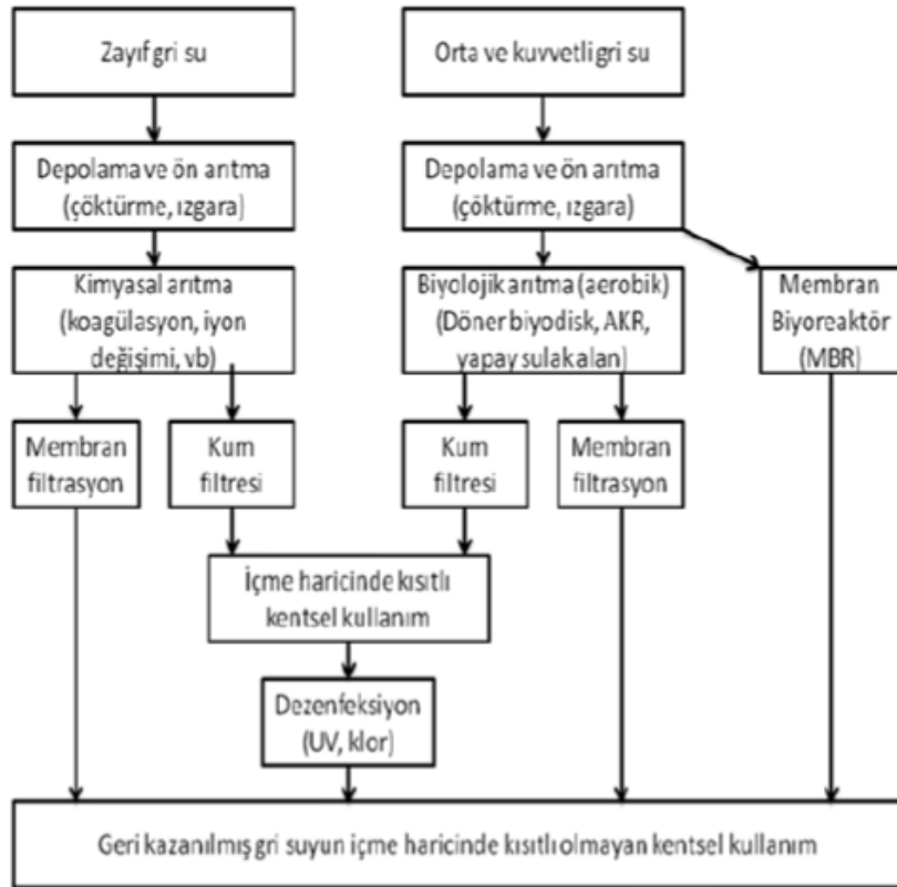
Şekil 4.7 Kaynağına göre gri suların arıtılması yöntemleri [51]
