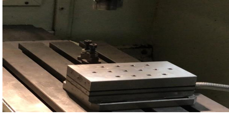
Şekil 2.4 Dinamometrenin Tezgaha Bağlanan Kısım
