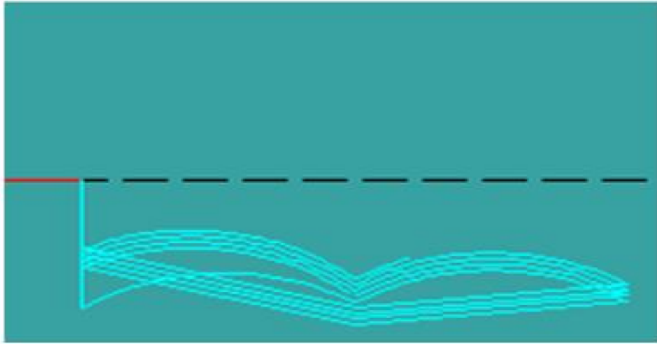
Şekil 1.18 Kardiod ( \infty ) formunda trokoidal frezeleme işleminde takım yolu (2B)
