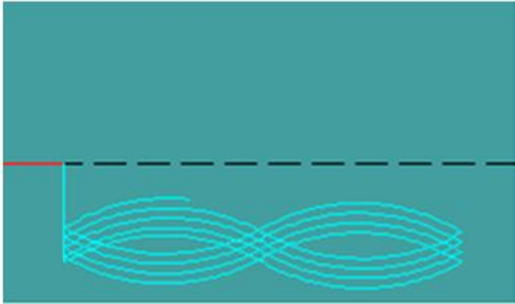
Şekil 1.20 Sonsuz (∞) trokoidal frezeleme işleminde takım yolu (2B)
