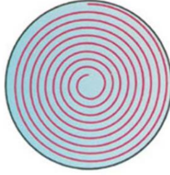
Şekil 1.7 Spiral frezeleme esnasında takımın izlediği yol [7]
