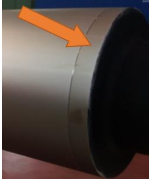
Şekil 4.9 PDT yönteminde deneme pürüzlendirme yapılan bölge
