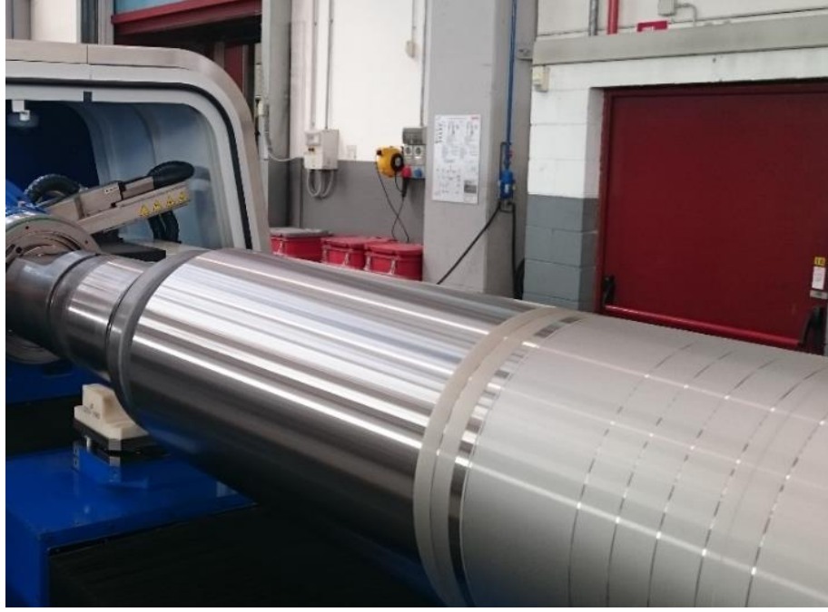
Şekil 5.1 Pomini İtalya tesisinde PDT tezgahına takılı test merdanesi
