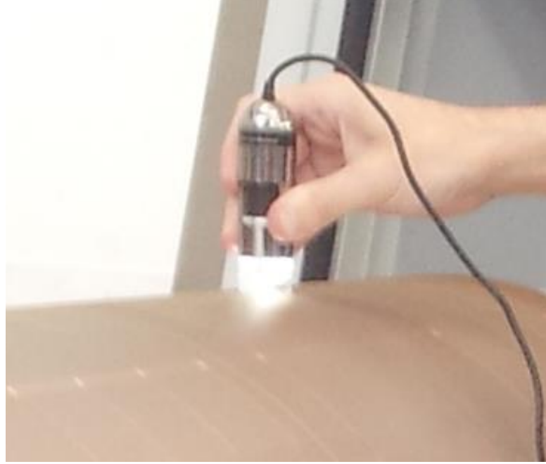
Şekil 5.5 Yüzey görünümünün elde edilmesinde kullanılan Dino-Lite cihazı
