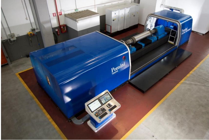
Şekil 4.12 PDT Tezgahı (Pomini/İtalya)
