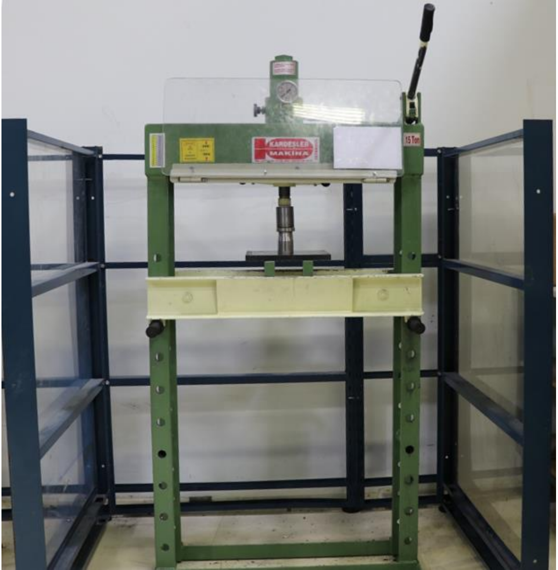
Şekil 5. 2 Testin Gerçekleştiği Hidrolik Pres
