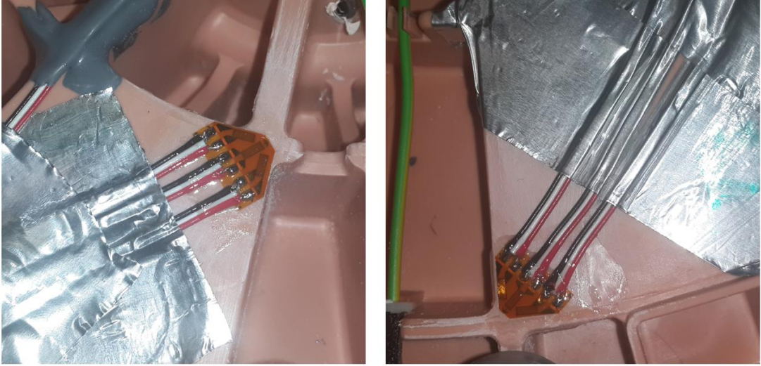
Şekil 4.3 R1 ve R2 bölgeleri üç eksenli rozet tip gerinim ölçer uygulaması
