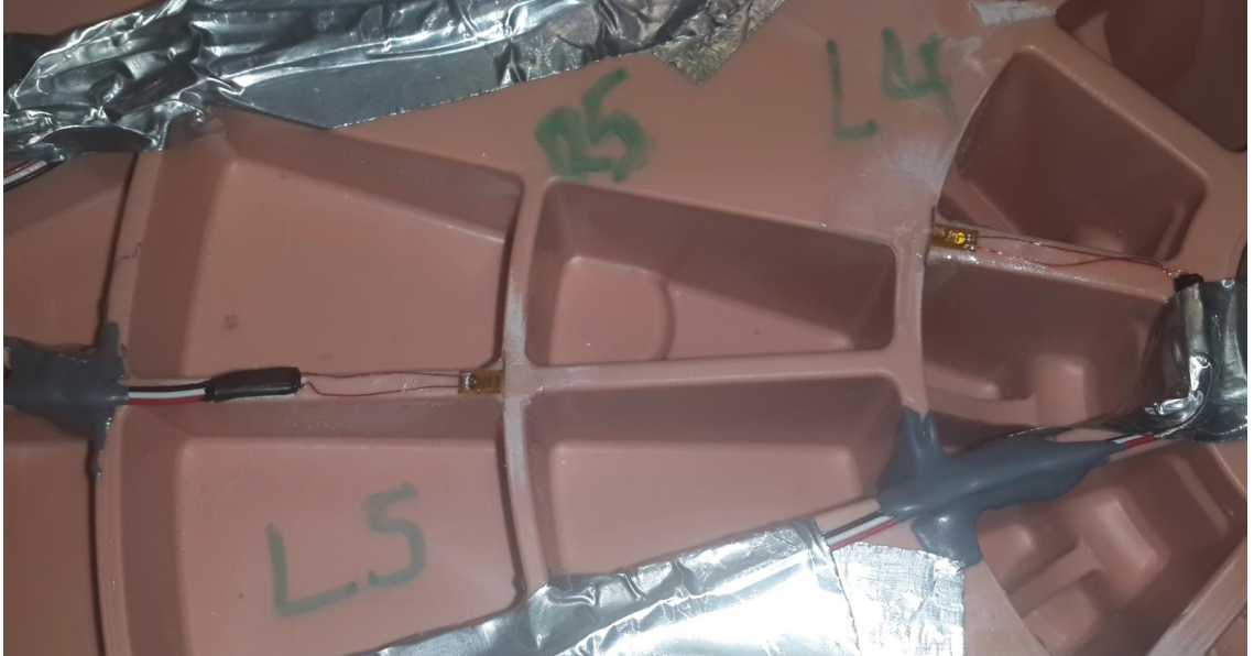
Şekil 4.2 L4 ve L5 bölgeleri tek eksenli gerinim ölçer uygulaması
