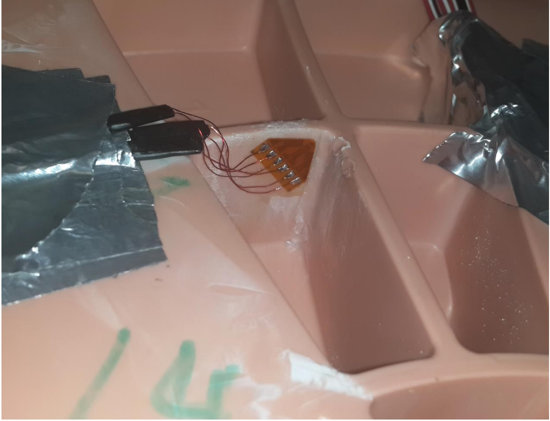
Şekil 4.5 R5 bölgesi üç eksenli rozet tip gerinim ölçer uygulaması
