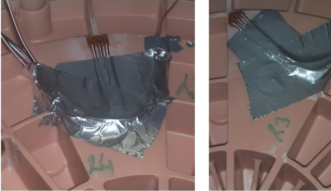
Şekil 4.4 R3 ve R4 bölgeleri üç eksenli rozet tip gerinim ölçer uygulaması
