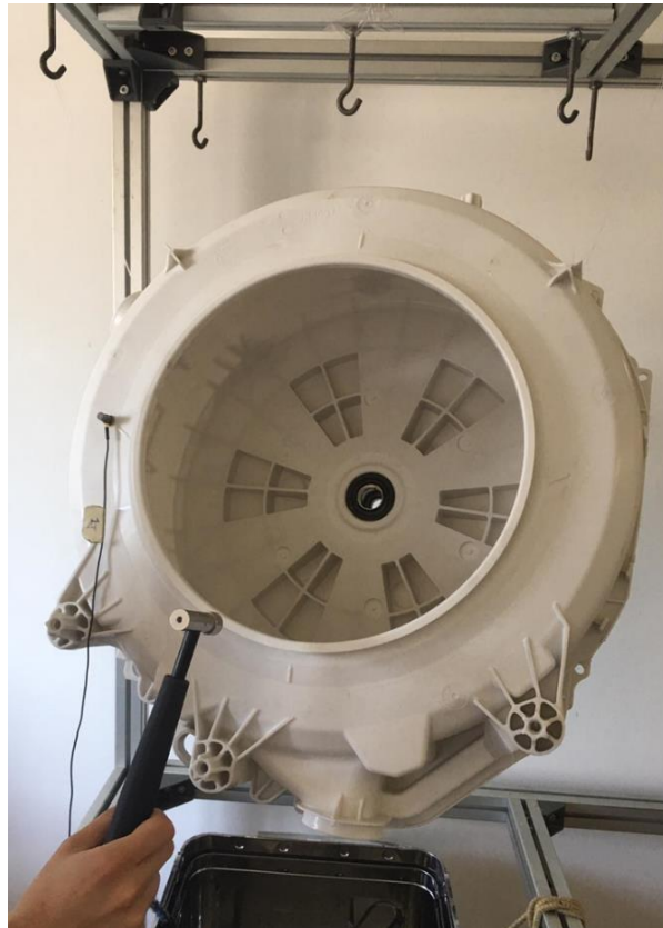
Şekil 5.13 Çekici testi düzeneđi, ivmeölçer ve kazan plastiđi
