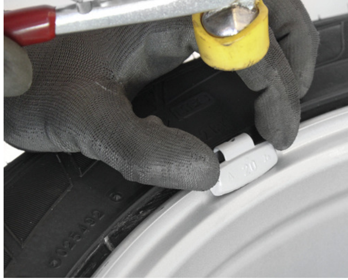
Şekil 2.13 Çeneli Tip Balans Ağırlığının Çelik Janta Montajı
