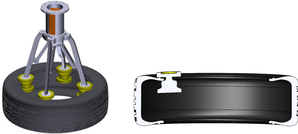
Şekil 3.16 Lastik Jant Tutucusu - Çenelerin Lastiği Yakalaması
