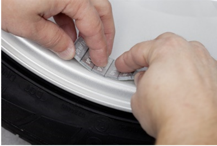
Şekil 2.14 Yapıştırma Tip Balans Ağırlığının Alaşım Janta Montajı
