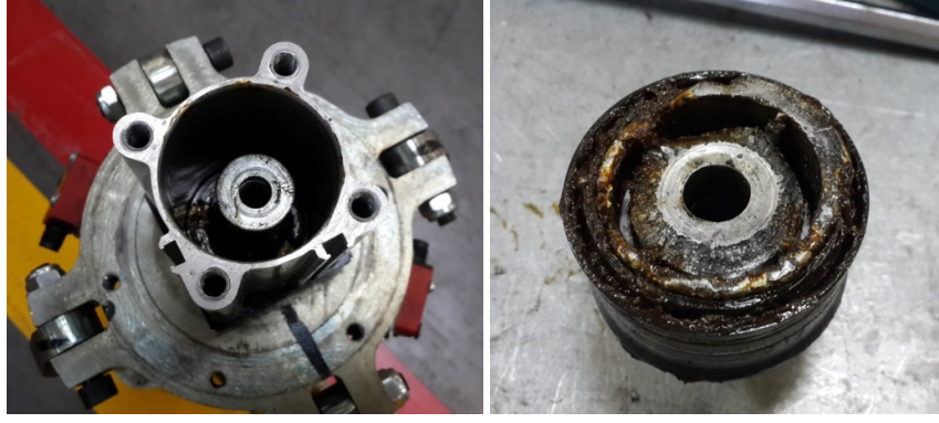
Şekil 5.1 Pnömatik Piston Kırılma Yüzeyi
