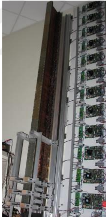
Şekil 2.10 Sabancı Üniversitesi tarafından yapılan, lineer motorla çalışan bir asansör için deneme sürüşü [16].
