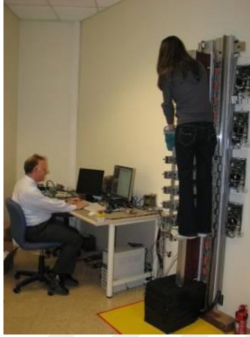
Şekil 2.11 Sabancı Üniversitesi tarafından yapılan, lineer motorla çalışan bir asansör için deneme sürüşü [16].
