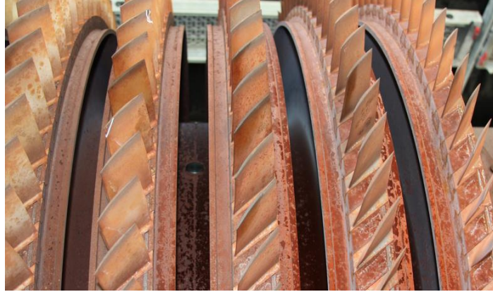
Şekil 2.26 Kanatçık Korozyon Örneği [51]
