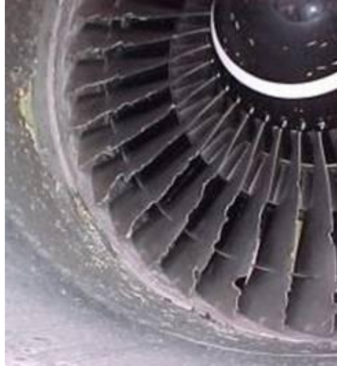
Şekil 3.2 Martı Çarpması Sonucu Boeing 747 Motoruna Ait Fan Kanatlarında Hasar Örneği [54]
