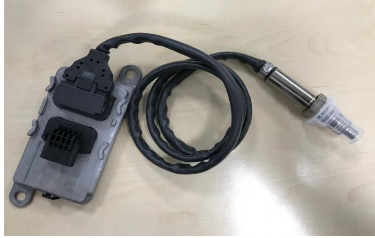
Şekil 3.5 Motor üzerinde bulunan dahili NO x sensörü
