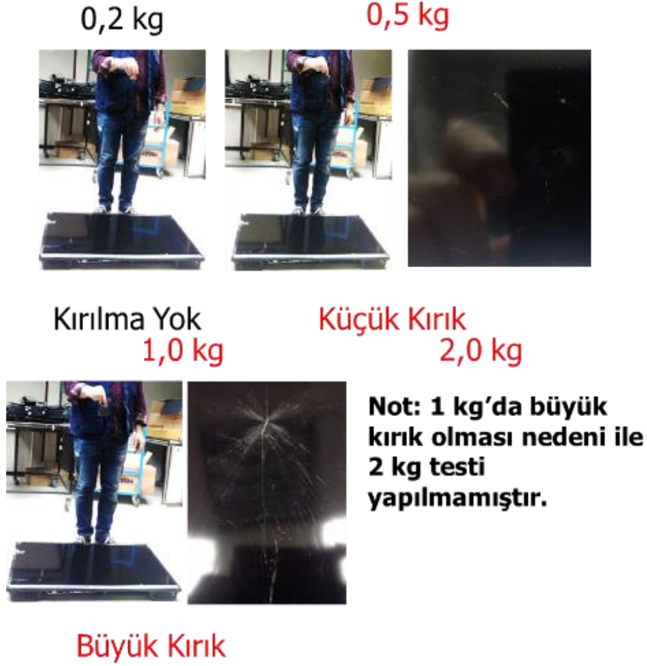
Şekil 4.8 0,5 mm cam kalınlığına sahip TV'lere yapılan ağırlık düşürme testleri (straforsuz)
