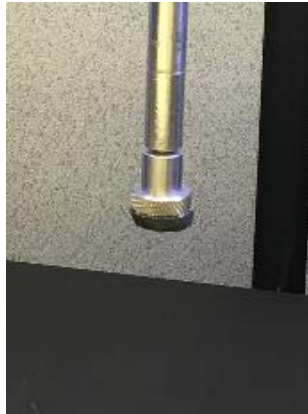
Şekil 4.1 Basma deney cihazının kuvvet uygulayan çubuğu ve ucuna yapıştırılmış sünger
