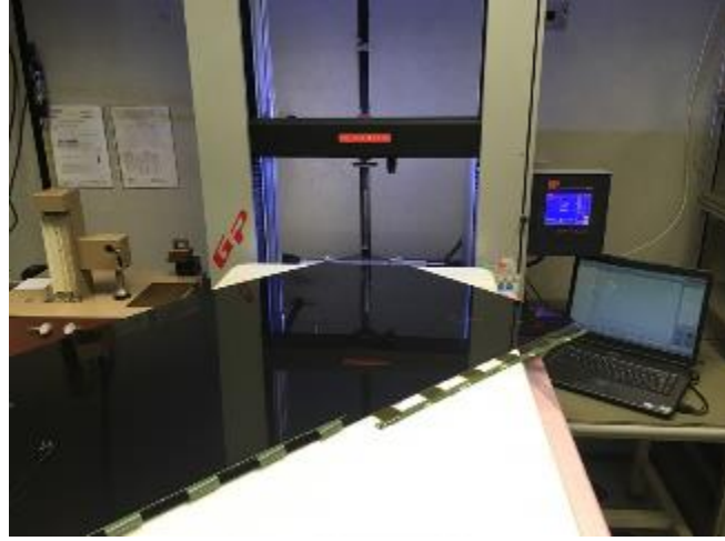
Şekil 4.2 Test sırasında yatay duracak şekilde sabitlenmiş open cell
