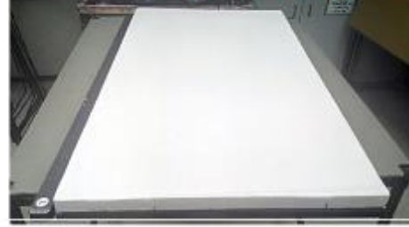
Komple – panel strafor-5 dk–kırılmadı (0/1) 15 dk–kırılmadı (0/3)
