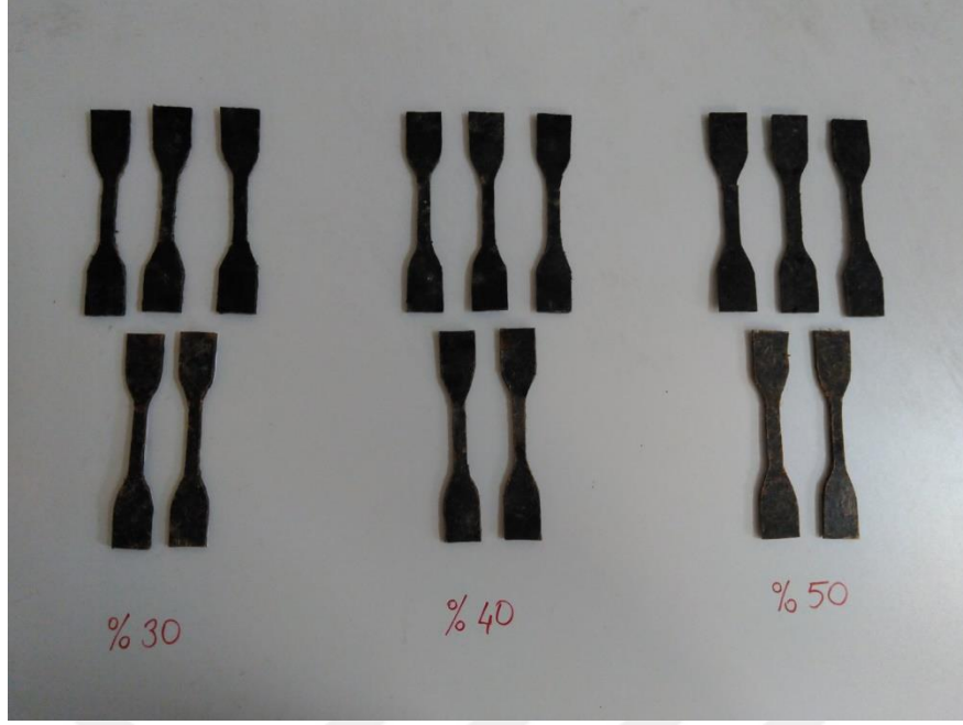
Şekil 5.23 Kesilmiş Çekme Numuneleri
