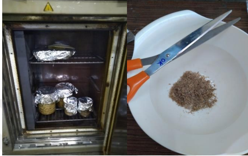
Şekil 5.6 Sırasıyla Liflerin Fırında Kurutulması ve İstenen Boyutlarda Kesilmesi
