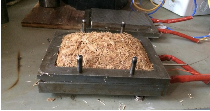
Şekil 5.11 Numunenin Kalıba Yerleşimi
