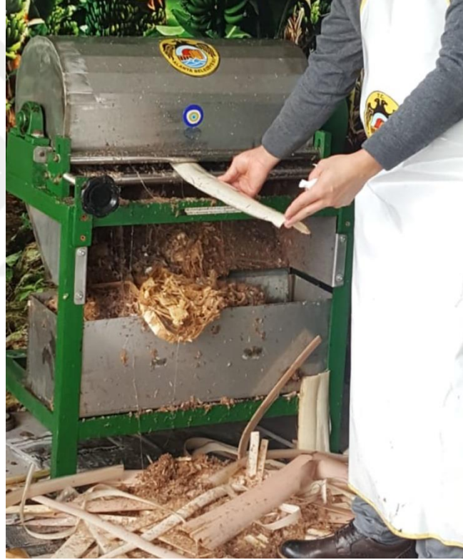
Şekil 5.3 Kılıfların Muz Liflerine Dönüştürülmesi
