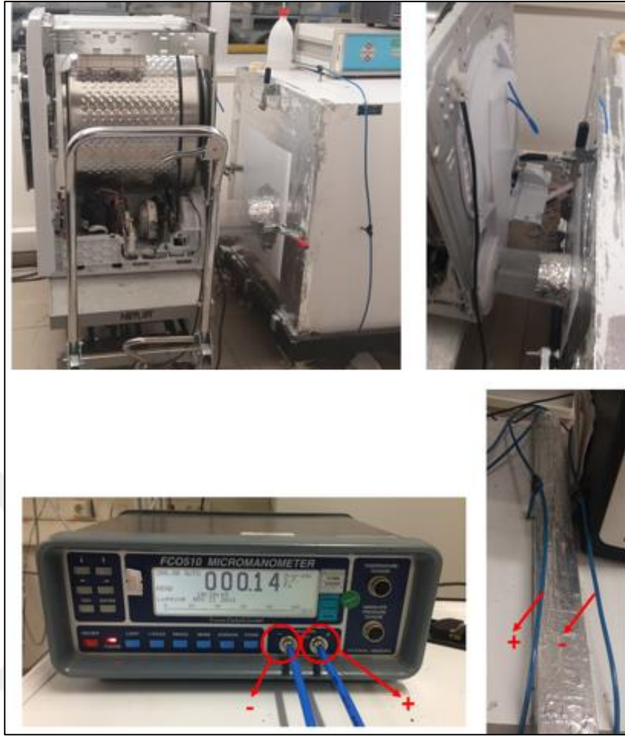
Şekil 3.9 Rüzgâr tüneli debi ölçüm deney düzeneği [11]
