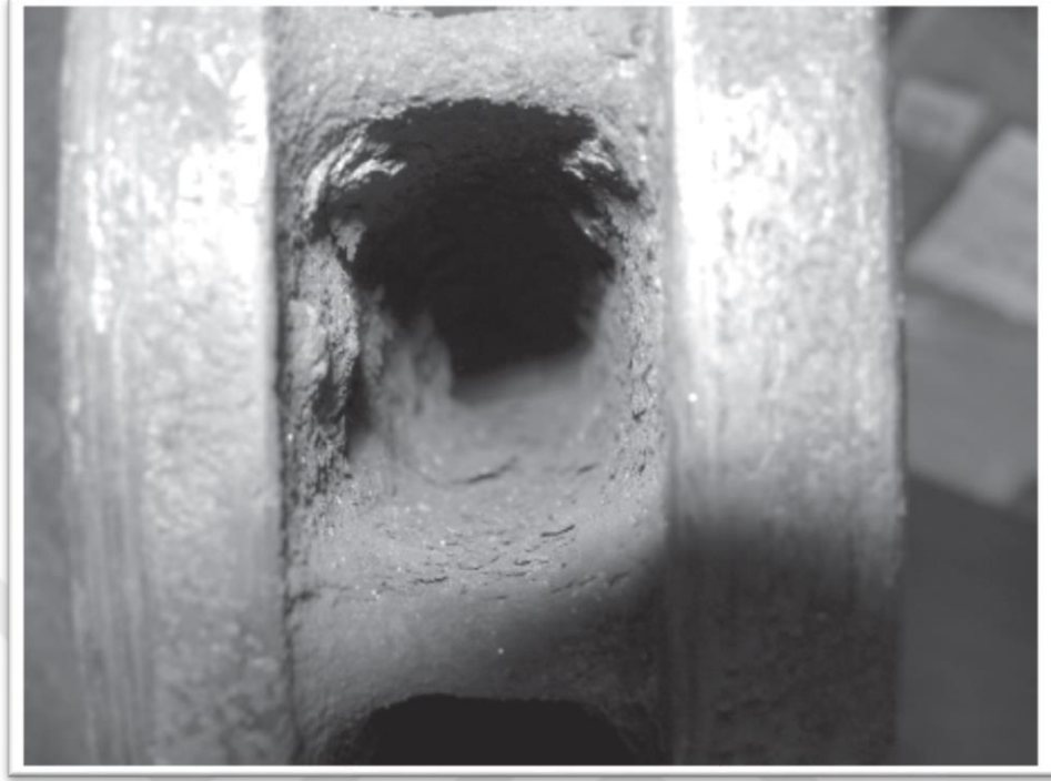
Şekil 4. 1 Pas sebebiyle soğutma hava akışının azaldığı disk kanatları
