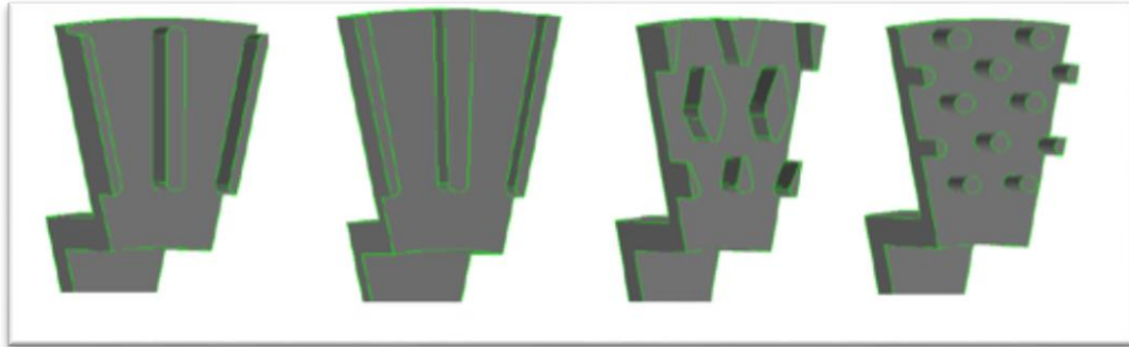
Şekil 3. 5 a) Düz b) Açılı konik radyal c) Elmas sütunlu d) Dairesel sütunlu disk kanat tasarımı [11]
