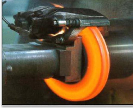
Şekil 2. 15 Dinamometre testinde yüksek sıcaklıktaki fren disk [8]
