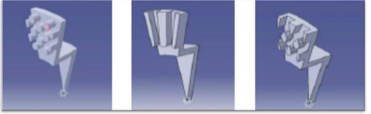
Şekil 3. 1 Kanatçık tasarımına göre disk tasarımı a) dairesel b) açılı konik radyal c) elmas sütunlu [9]
