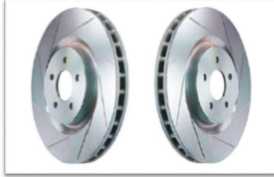
Şekil 2. 12 Performans araçları için geliştirilen havalandırma kanatlı disk tasarımı
