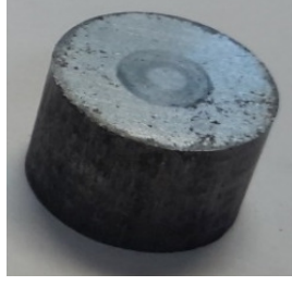
Şekil 3.20 1 wt% GNP, 1 saat öğütülmüş, 630 °C'de 1 saat sinterlenmiş aşınma numunesi
