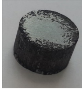
Şekil 3.8 0,5 wt% GNP, 630 °C'de 1 saat sinterlenmiş aşınma numunesi
