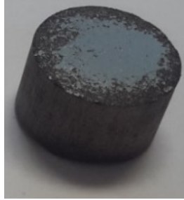
Şekil 3.32 2 wt% GNP, 2 saat öğütülmüş, 630 °C'de 1 saat sinterlenmiş aşınma numunesi
