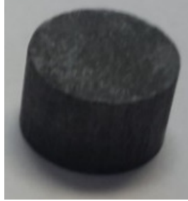
Şekil 3.26 1 wt% GNP, 4 saat öğütülmüş, 630 °C'de 1 saat sinterlenmiş aşınma numunesi
