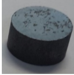
Şekil 3.17 0,5 wt% GNP, 4 saat öğütülmüş, 630 °C'de 1 saat sinterlenmiş aşınma numunesi
