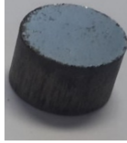
Şekil 1.35 2 wt% GNP, 4 saat öğütülmüş, 630 °C'de 1 saat sinterlenmiş aşınma numunesi
