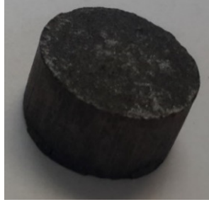
Şekil 3.14 0,5 wt% GNP, 2 saat öğütülmüş, 630 °C'de 1 saat sinterlenmiş aşınma numunmesi
