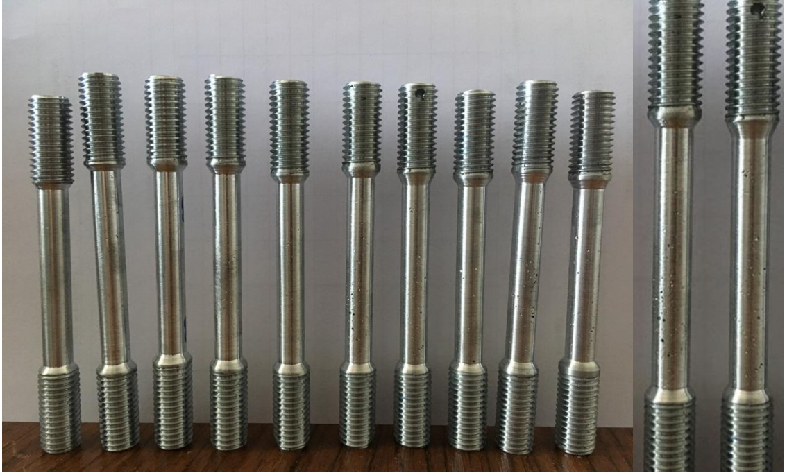
Şekil 8.6 Çekme numuneleri ve meydana gelen porozitelere ait görseller
