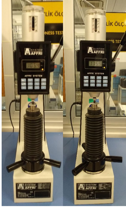
Şekil 8.8 AFFRİ SYSTEM marka 206 TD model sertlik ölçüm cihazı ile elde edilen sertlik değerleri
