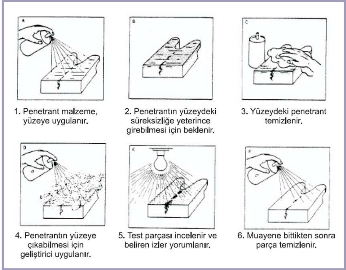
Şekil 5.1 Sıvı penetran ile muayenenin temel aşamaları [40]
