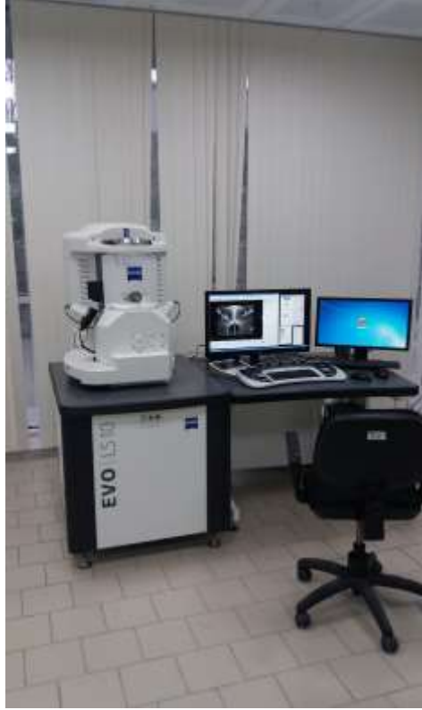
Şekil 6.5 Yüzey incelemesinde kullanılan SEM görüntüleme cihazı
