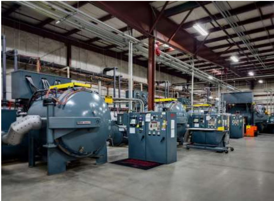
Şekil 3.11 Vakum ortamında sert lehimleme iin kullanılan fırınlar [45]
