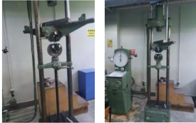
Şekil 6.4 Deneyde kullanılan çekme makinesi
