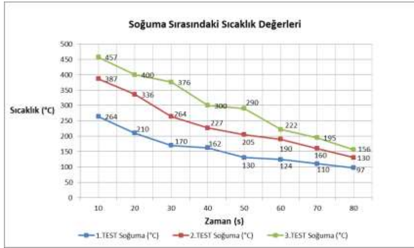
Şekil 7.3 Bindirme yöntemi ile azot gazı kullanılmadan yapılan sert lehimleme işlemi sonrasında oda sıcaklığında soğuma sırasında bağlantı bölgesinin sıcaklık değişimleri
