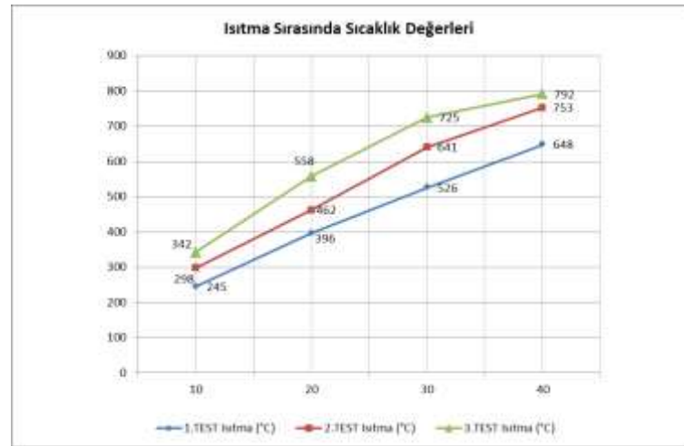
Şekil 7.1 Bindirme yöntemi ile azot gazı kullanılmadan yapılan sert lehimleme işleminde bağlantı bölgesinde ısıtma sırasındaki sıcaklık değişimleri
