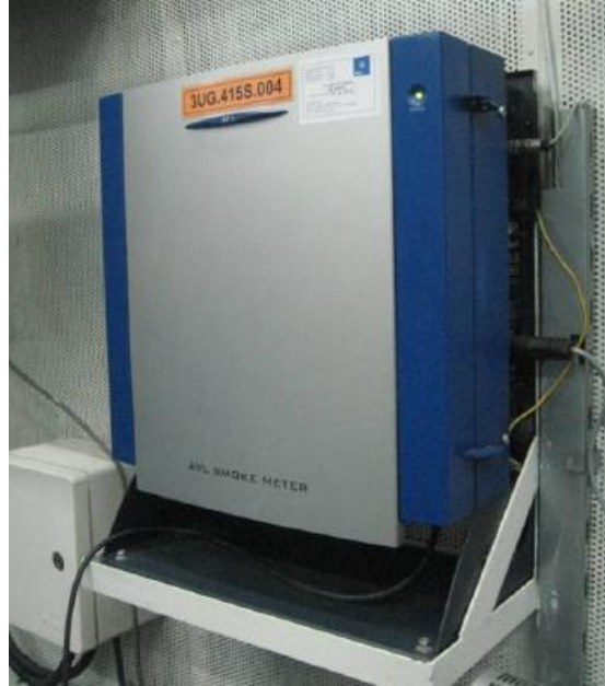
Şekil 3. 5 Deneylerde kullanılmış olan AVL 415S is olcum cihazı
