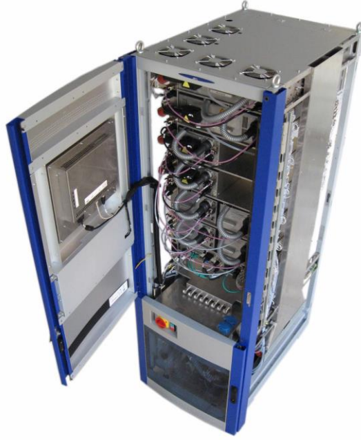
Şekil 3. 6 Deneylerde kullanılmış olan AVL i60 egzoz emisyon ölçüm cihazı
