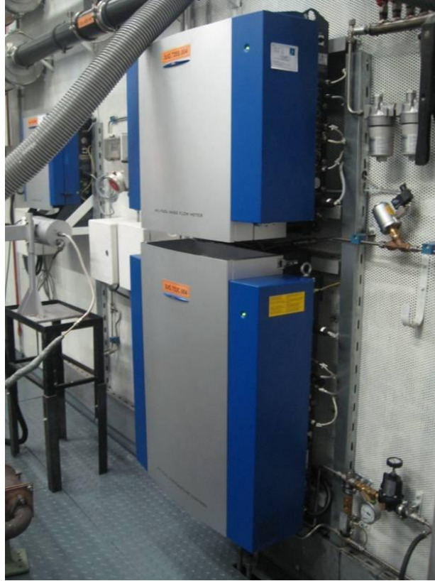
Şekil 3. 4 Deneylerde kullanılmış olan AVL 735S yakıt sarfiyatı ölçüm ve AVL 735C yakıt sıcaklığı kontrol cihazı kombinasyonu.
