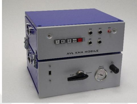
Şekil 2. 26 Örnek bir yakıt tüketimi ölçüm cihazı
