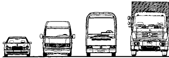
Şekil 2. 22 Farklı taşıt tiplerinin ön izdüşüm alanları [62]
